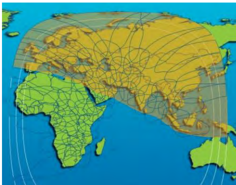
Рис. 112. ЭИИМ (дБ·Вт) в рабочих зонах (многолучевая) ИСЗ INTELSAT-33e (60° в.д.) в Ku-диапазоне частот
