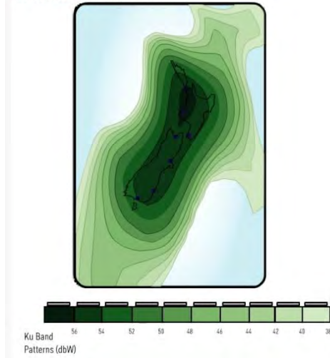
Рис. 7. ЭИИМ (дБ·Вт) в рабочих зонах ИСЗ OPTUS-D1 (160° в.д.) в Ку-диапазоне частот
