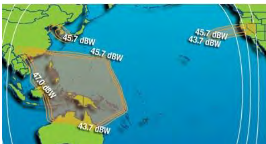
Рис. 95. ЭИИМ (дБ·Вт) в рабочих зонах (юго-запад Тихоокеанской зоны, Корейский п-ов и Калифорния) ИСЗ INTELSAT-19 (166° в.д.) в Ku-диапазоне частот
