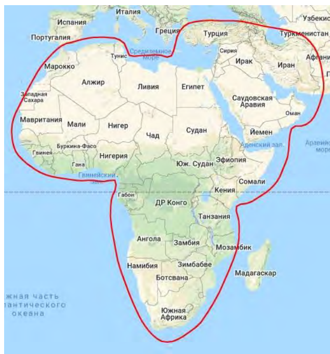
Рис. 38. Рабочие зоны ИСЗ ARABSAT-6A (30,5° в.д.) в Ka-диапазоне частот
