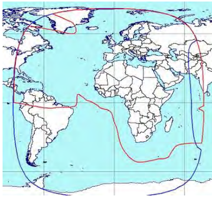
а) б) Рис. 7. Рабочие зоны (а) и ЭИИМ (дБ·Вт) в рабочих зонах (б) ИСЗ ATLANTIC BIRD-3 (5° з.д.) в С-диапазоне частот
