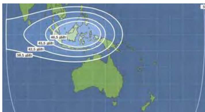
Рис. 2. ЭИИМ (дБВт) в рабочей зоне (перенацеливаемый луч) ИСЗ ЭКСПРЕСС-АМ3 (140° в.д.) в С-диапазоне частот
