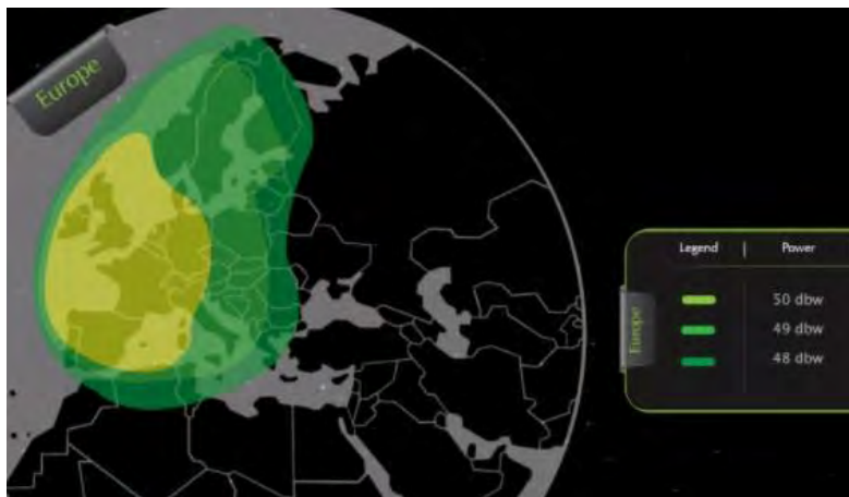
Рис. 1. ЭИИМ (дБ·Вт) в рабочих зонах ИСЗ YAHSAT-1A (52,5° в.д.) в С-диапазоне частот (услуга YahLink)
