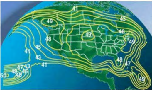
Рис. 60. ЭИИМ (дБ·Вт) в североамериканской рабочей зоне ИСЗ GALAXY-28 (INTELSAT-A8, 89° з.д.) в Ku-диапазоне частот
