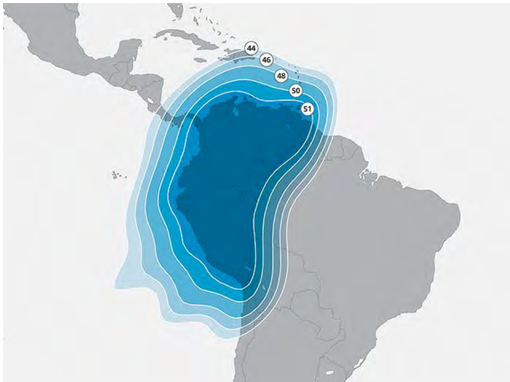
Рис. 131. ЭИИМ (дБ Вт) в рабочих зонах (северо-запад Южной Америки) ИСЗ SES-14 (47,5° з.д.) в Ku-диапазоне частот
