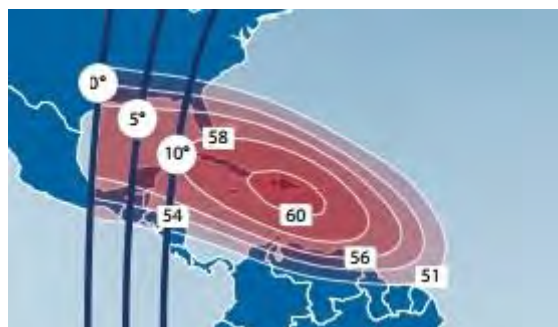
Рис. 51. ЭИИМ (дБ·Вт) в рабочих зонах (четыре зональных луча) ИСЗ TELSTAR-12 VANTAGE (15° з.д.) в Ки-диапазоне частот
