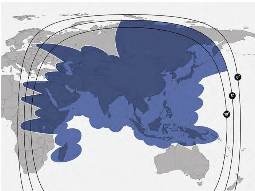
Рис. 141. ЭИИМ (дБ Вт) в рабочих зонах (многолучевая антенна) ИСЗ SES-12 (95° в.д.) в Ku-диапазоне частот
