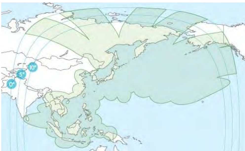
Рис. 21. Рабочие зоны ИСЗ JCSAT-18 (150° в.д.) в Ku-диапазоне частот
