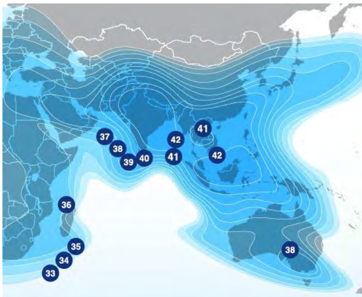
Рис. 11. ЭИИМ (дБ·Вт) в рабочих зонах (а – индийский, б – индонезийский, в - малазийский и г – австралийский лучи) ИСЗ MEASAT-3B (91,5° в.д.) в Ku- диапазоне частот
