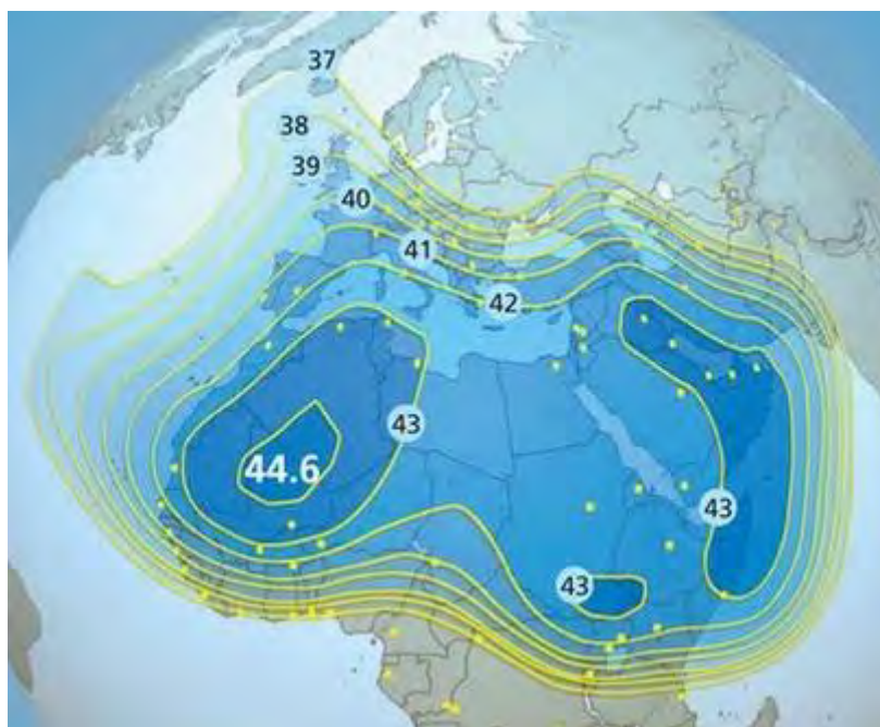
Рис. 39. Планирующаяся ЭИИМ (дБ Вт) в рабочих зонах ИСЗ ARABSAT-6E (34,5° в.д.) в стандартном C-диапазоне частот
