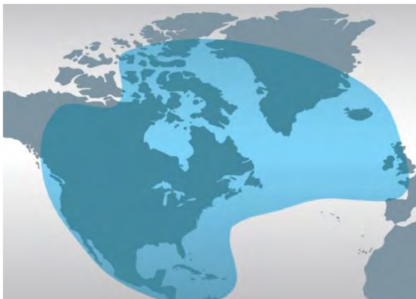
Рис. 101. Рабочие зоны ИСЗ VIASAT-2 (69,9° з.д.) в Ka-диапазоне частот
