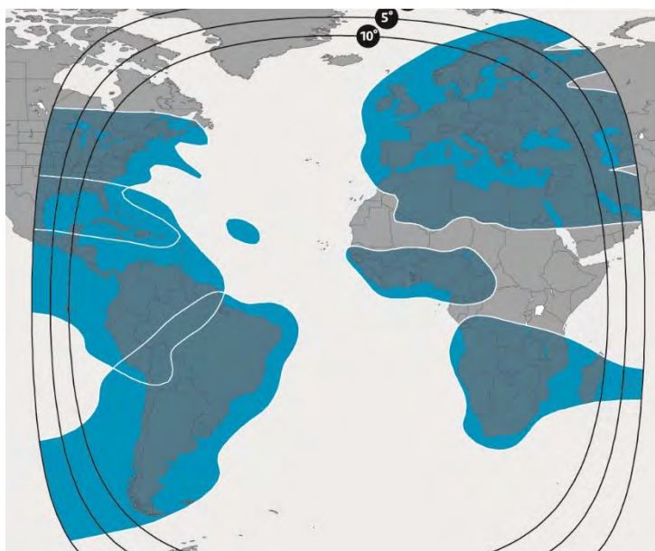
Рис. 18. Рабочие зоны ИСЗ NSS-7 (20° з.д.) в Ku-диапазоне частот
