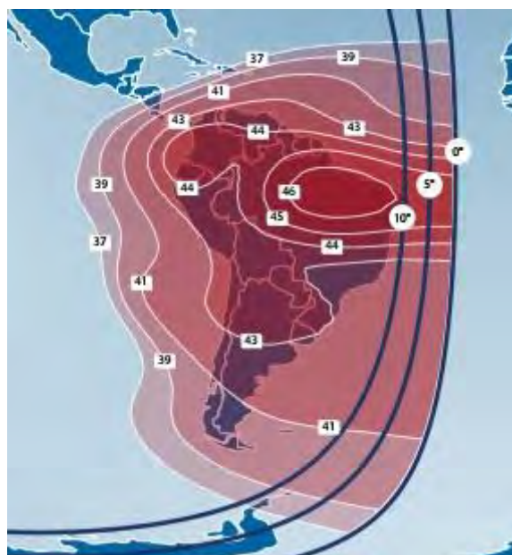
Рис. 46. ЭИИМ (дБ·Вт) в рабочих зонах ИСЗ ANIK-G1 (107,3° з.д.) в С-диапазоне частот
