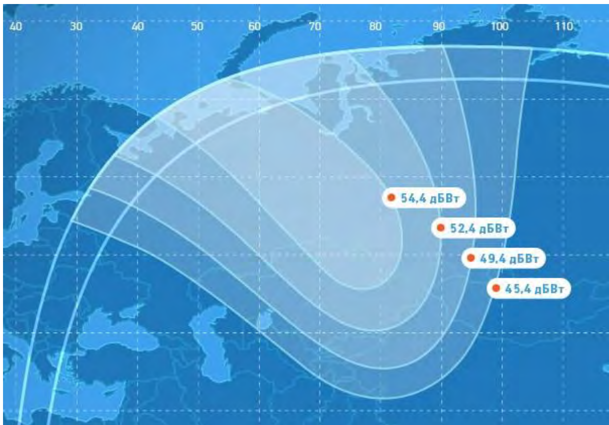
Рис. 10. ЭИИМ (дБВт) в рабочей зоне (1-й вариант перенацеливаемого луча) ИСЗ ЭКСПРЕСС-АМ33 (96,5° в.д.) в Ku-диапазоне частот
