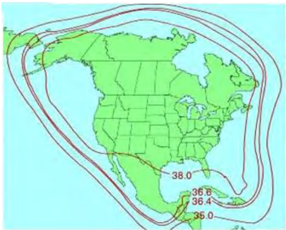
Рис. 11. ЭИИМ (дБ·Вт) в рабочих зонах ИСЗ AMSC и TMI в Ku-диапазоне частот
