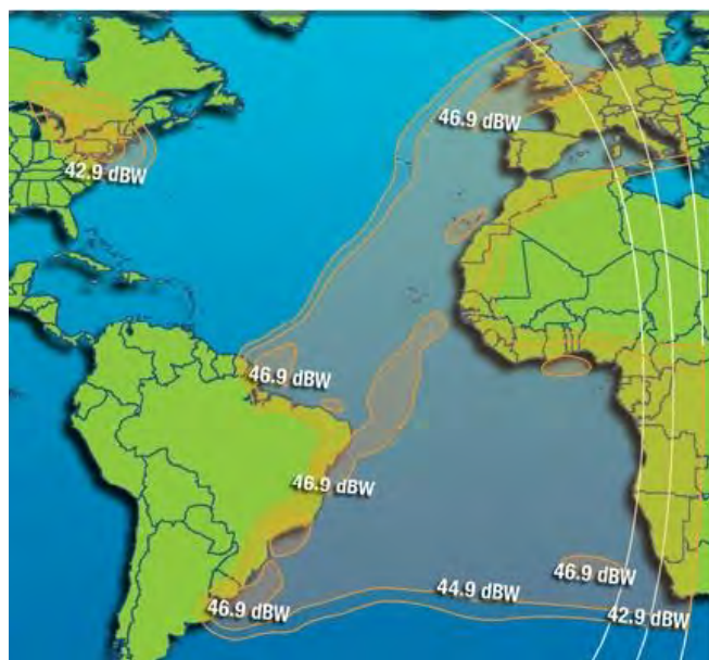
Рис. 101. ЭИИМ (дБ·Вт) в рабочих зонах (подвижные абоненты) ИСЗ INTELSAT-21 (58° з.д.) в Ku-диапазоне частот
