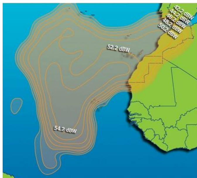
Рис. 74. ЭИИМ (дБ·Вт) в рабочих зонах ИСЗ INTELSAT-25 (31,5° з.д.) в С-диапазоне частот
