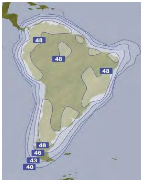
Рис. 26. ЭИИМ (дБ-Вт) в рабочей зоне (на Южную Америку) ИСЗ AMAZONAS-2 (61° з.д.) в Ku-диапазоне частот
