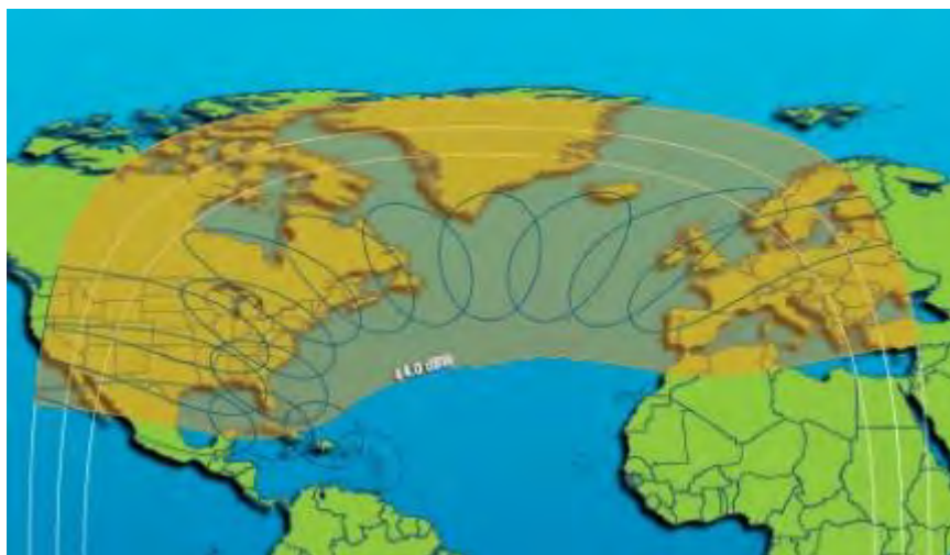
Рис. 1.14. ЭИИМ (дБ·Вт) в рабочих зонах (многолучевая) ИСЗ INTELSAT-32e (43,1° з.д.) в Ku-диапазоне частот
