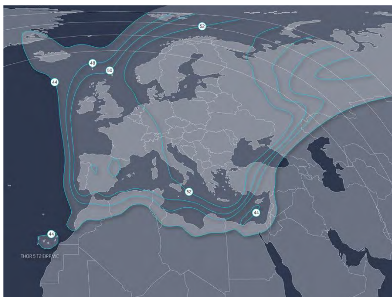
Рис. 4. ЭИИМ (дБ·Вт) в рабочих зонах (Т2) ИСЗ THOR-5 (0,7° з.д.) в Ku-диапазоне частот
