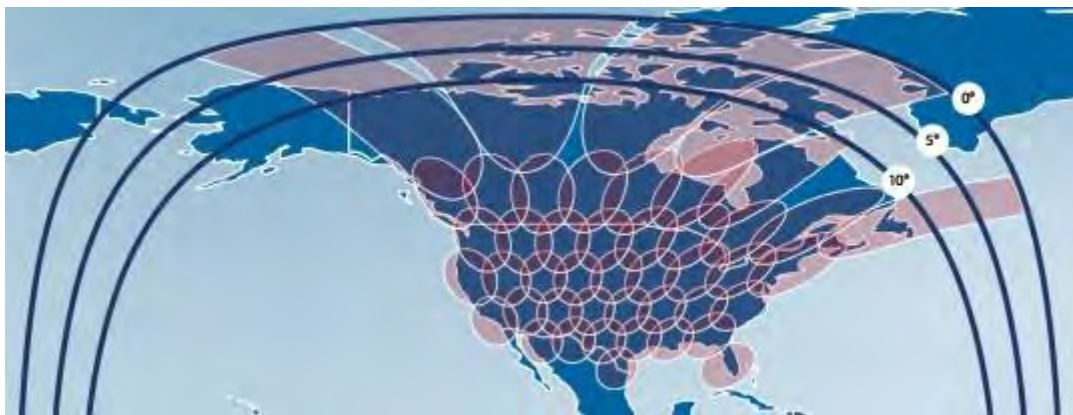
Рис. 32. ЭИИМ (дБ·Вт) в рабочей зоне (Северная Америка) ИСЗ ANIK-F2 (111,1° з.д.) в Ka-диапазоне частот
