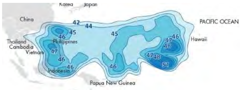
Рис. 46. ЭИИМ (дБ Вт) в рабочих зонах (8 ретрансляторов с полосами частот по 27 МГц, горизонтальная поляризация, южный луч) ИСЗ ABS-6 (ABS-1, LMI-1) (159° в.д.) в Ku-диапазоне частот
