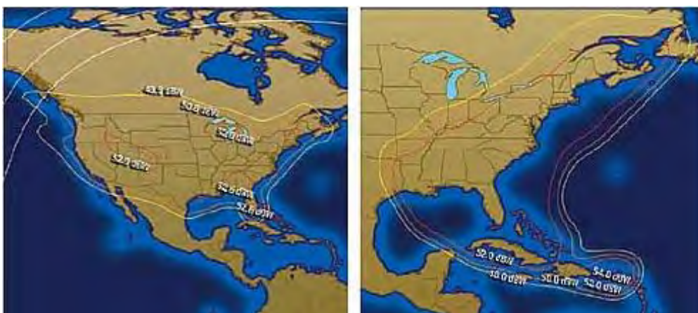
Рис. 94. Рабочие зоны ИСЗ HORIZONS-2 (74° з.д.) в Ки-диапазоне частот
