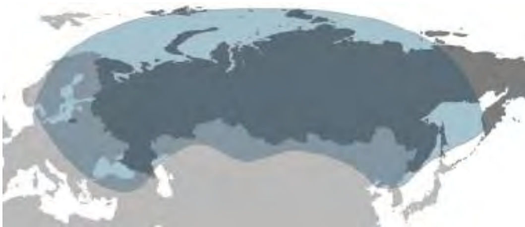
Рис. 74. Планируемые рабочие зоны ИСЗ ЯМАЛ-501 (82° в.д.) в Ku-диапазоне частот
