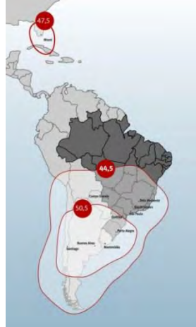
Рис. 10. ЭИИМ (дБ·Вт) в рабочей зоне (на страны Mercosur, Андского региона и штат Флорида, США) ИСЗ STAR ONE-C1 (65° з.д.) в Ки-диапазоне частот
