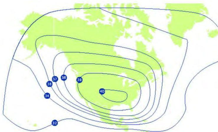
Рис. 44. ЭИИМ (дБ·Вт) в рабочих зонах (а - горизонтальная, б - вертикальная поляризация) ИСЗ GALAXY-3С (95° з.д.) в С-диапазоне частот
