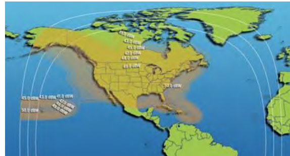
Рис. 60. ЭИИМ (дБ·Вт) в североамериканской рабочей зоне ИСЗ GALAXY-28 (INTELSAT-A8, 89° з.д.) в Ku-диапазоне частот
