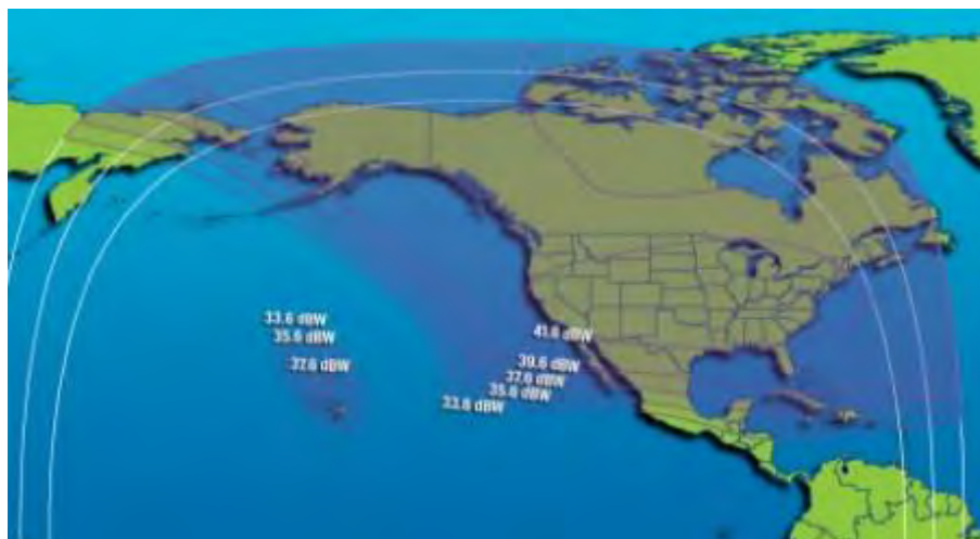
Рис. 66. ЭИИМ (дБ·Вт) в рабочих зонах ИСЗ GALAXY-15 (133° з.д.) в С-диапазоне частот
