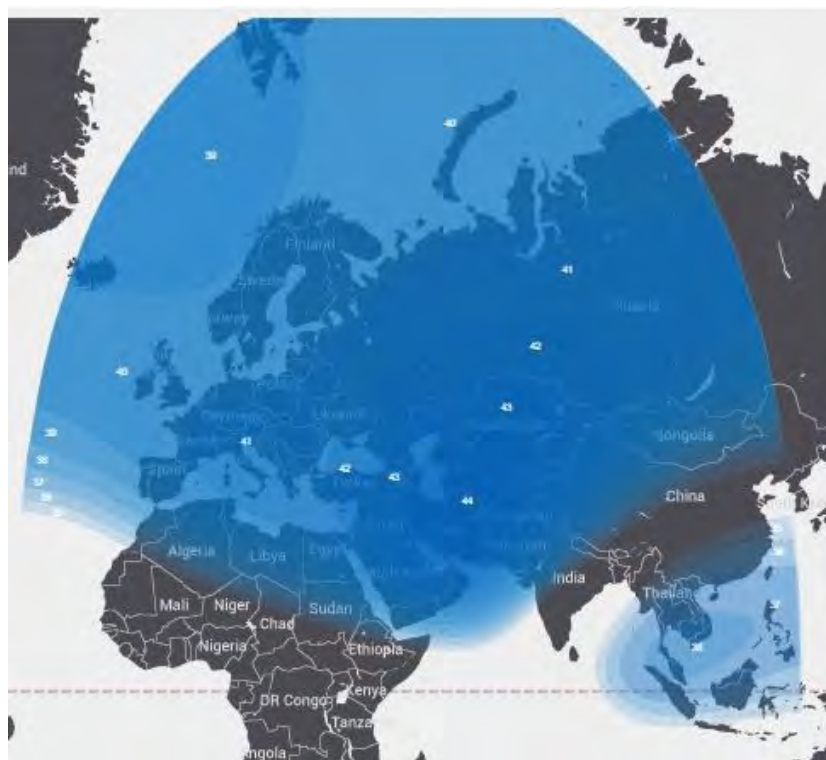
Рис. 10. ЭИИМ (дБ·Вт) в рабочих зонах (а – Африка, Европа и Индонезия, б – Центральная Азия и Европа) ИСЗ AFRICASAT-1/AZERSPACE-1 (46° в.д.) в С-диапазоне частот
