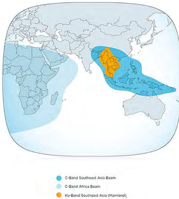
Рис. 27. Рабочие зоны ИСЗ THAIKOM-6 (78,5° в.д.) в С- и Ку-диапазонах частот
