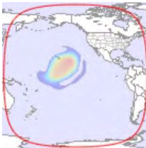
Рис. 3. Частотный план ретрансляторов (а) и рабочие зоны ИСЗ INTELSAT-5 (137° з.д.) в С- (б) и Ku- (в) диапазонах частот
