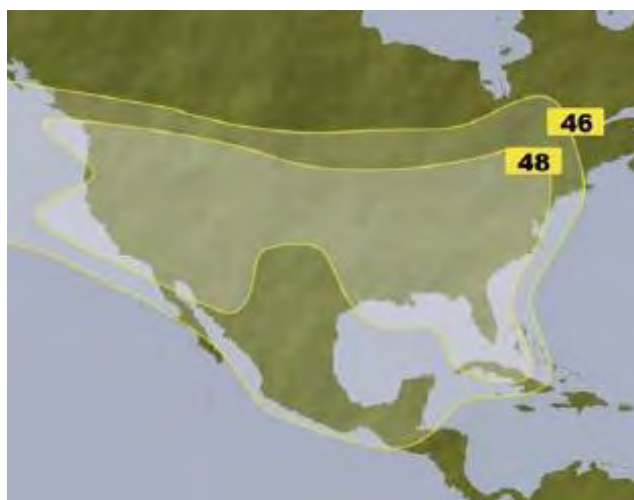
Рис. 25. ЭИИМ (дБ·Вт) в рабочей зоне (на Северную Америку) ИСЗ AMAZONAS-2 (61° з.д.) в Ku-диапазоне частот
