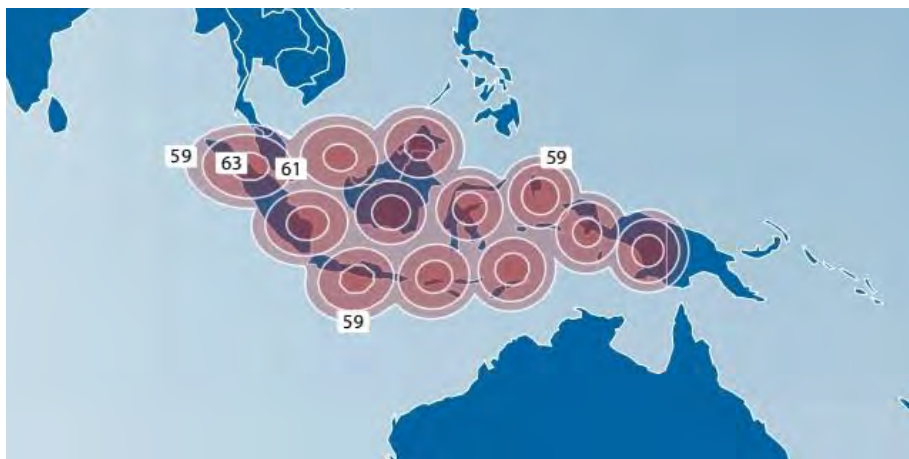
Рис. 22. ЭИИМ (дБ·Вт) в рабочих зонах (а – в С-диапазоне частот, б – шесть зональных лучей и в – 12 узких лучей в Ku-диапазоне частот) ИСЗ APSTAR-5C/TELSTAR-18 VANTAGE (138° в.д.)
