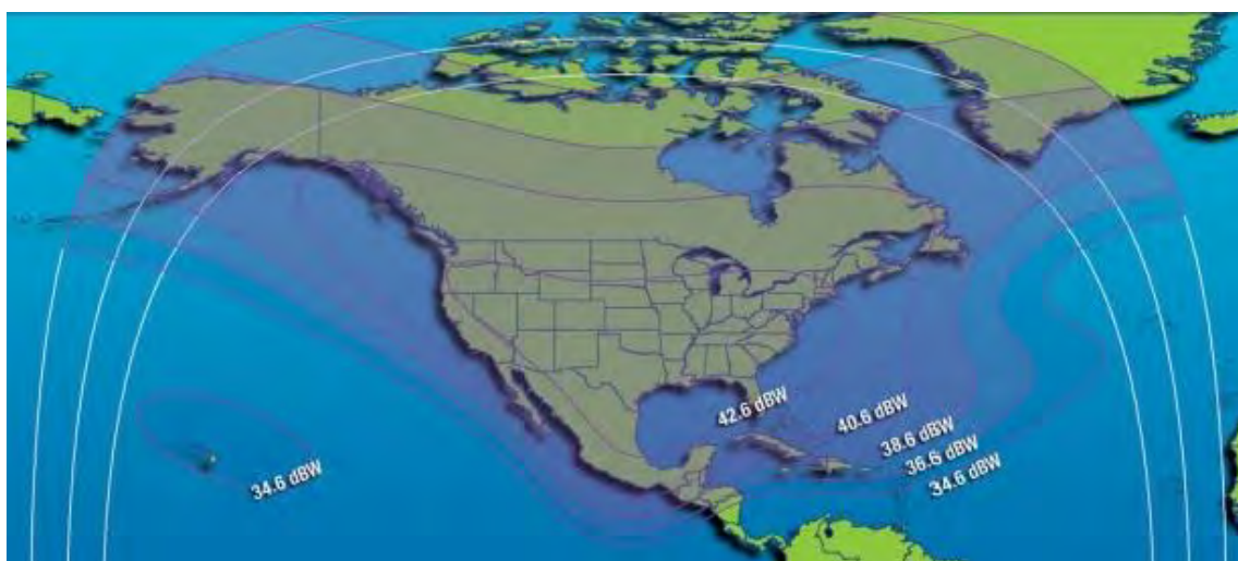
Рис. 66. ЭИИМ (дБ·Вт) в рабочих зонах ИСЗ GALAXY-15 (133° з.д.) в С-диапазоне частот
