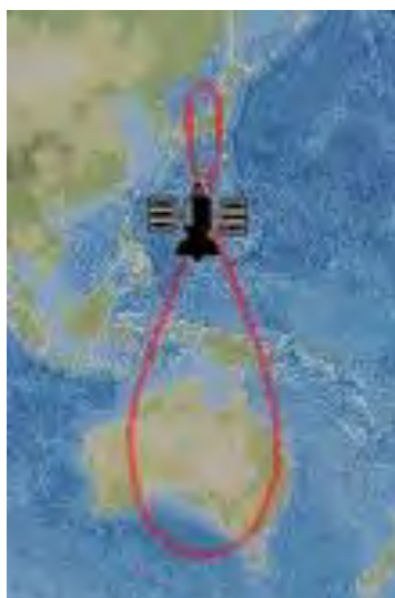
Рис. 3. Подспутниковая трасса ИСЗ MICIBIKI-1 (OZS-1)
