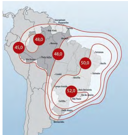
Рис. 13. ЭИИМ (дБ·Вт) в рабочей зоне (на Бразилию) ИСЗ STAR ONE-C2 (70° з.д.) в Ku-диапазоне частот
