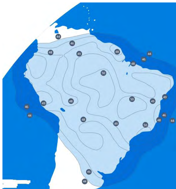
Рис. 16. ЭИИМ (дБ-Вт) в рабочих зонах (на Южную Америку) ИСЗ HISPASAT-36W-1 (36° з.д.) в Ки-диапазоне частот
