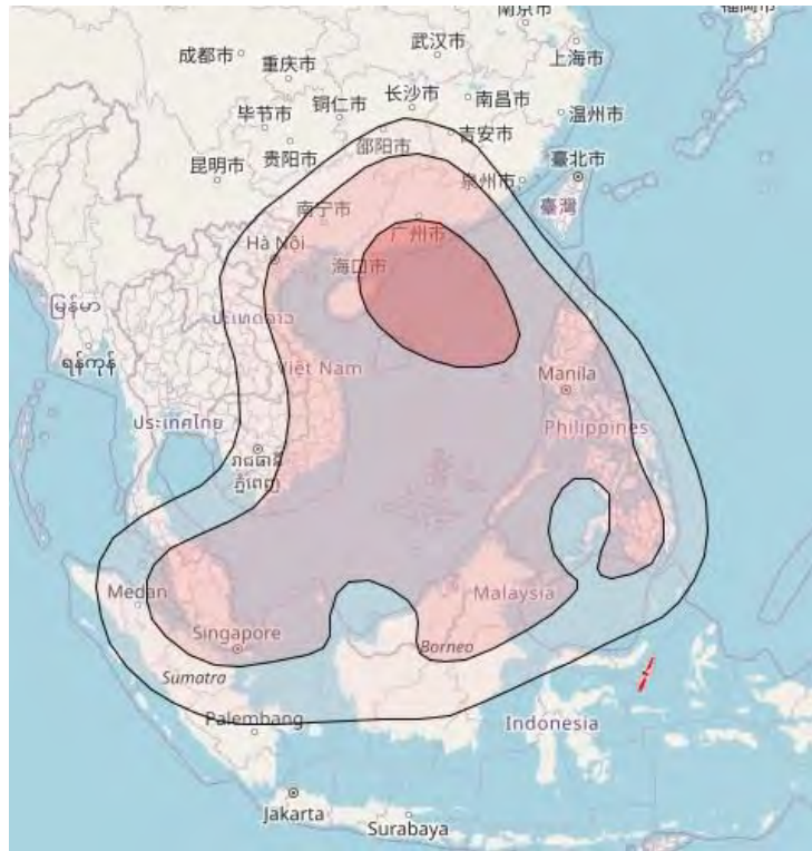
Рис. 24. Рабочие зоны (а – полуглобальная, б – контурная и в – перенацеливаемая) ИСЗ CHINASAT-6D (125° в.д.) в С-диапазоне частот
