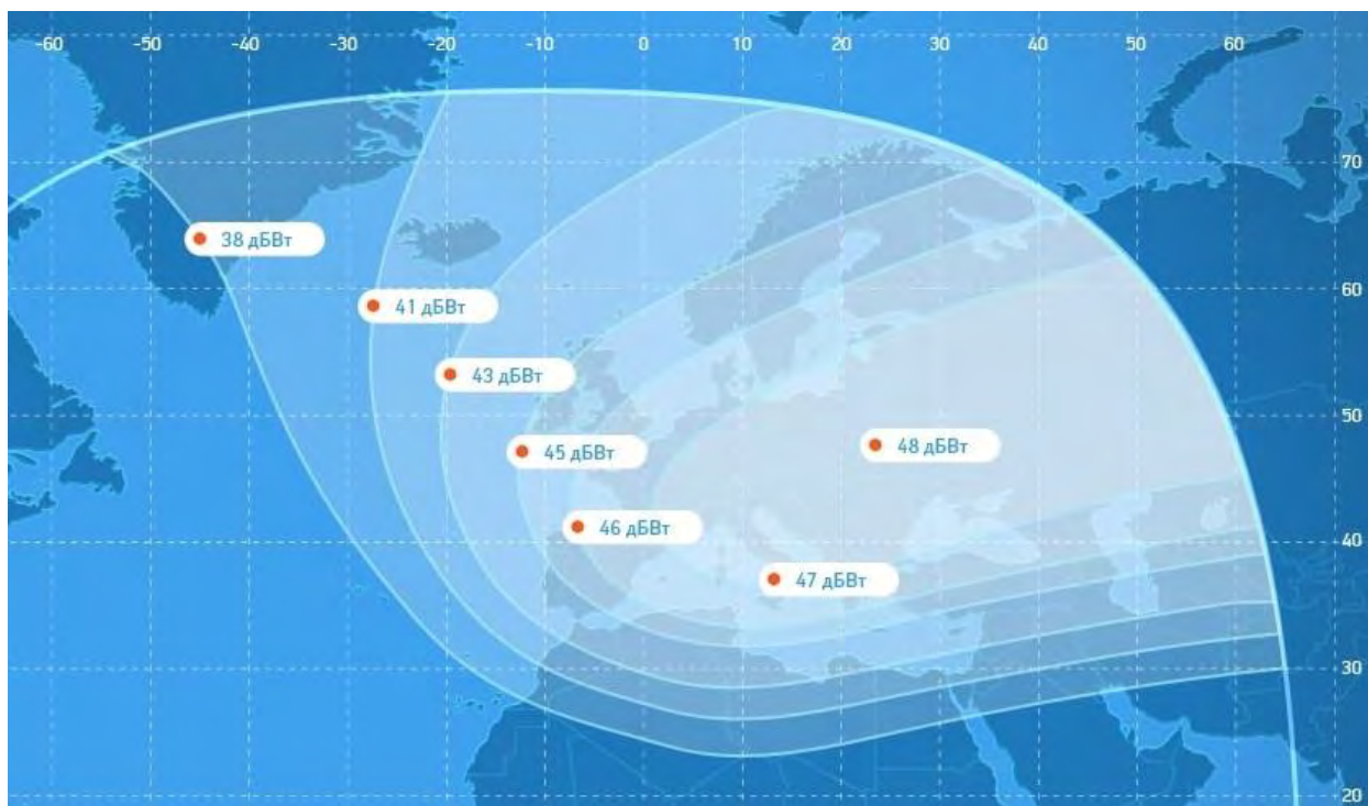
Рис. 12. ЭИИМ (дБВт) в рабочей зоне (перенацеливаемый луч) ИСЗ ЭКСПРЕСС-АМ44 (11° з.д.) в С-диапазоне частот
