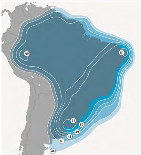
Рис. 93. ЭИИМ (дБ Вт) в рабочих зонах (Бразилия) ИСЗ SES-6 (40,5° з.д.) в Ки-диапазоне частот
