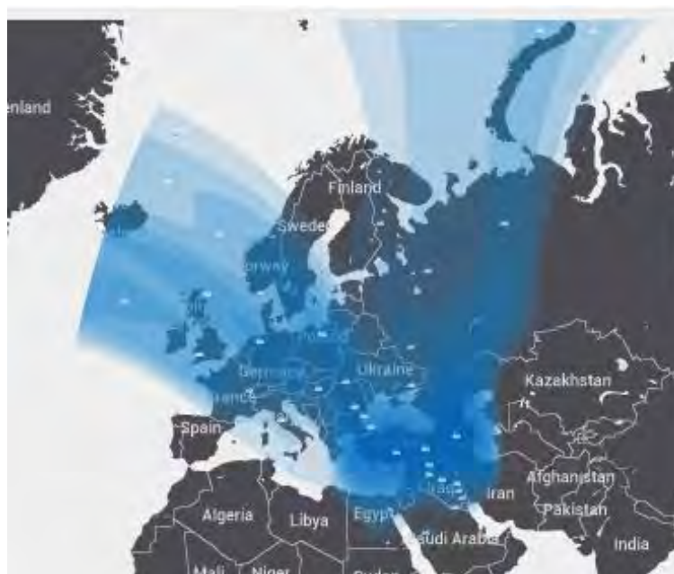
Рис. 4. ЭИИМ (дБ·Вт) в рабочих зонах (Европа) ИСЗ AFRICASAT-1/AZERSPACE-1 (46° в.д.) в Ku-диапазоне частот
