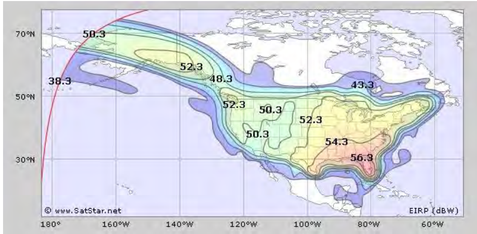
Рис. 64. ЭИИМ (дБ·Вт) в рабочей зоне на США ИСЗ Т10 (102,8° з.д.) в Ка-диапазоне частот
