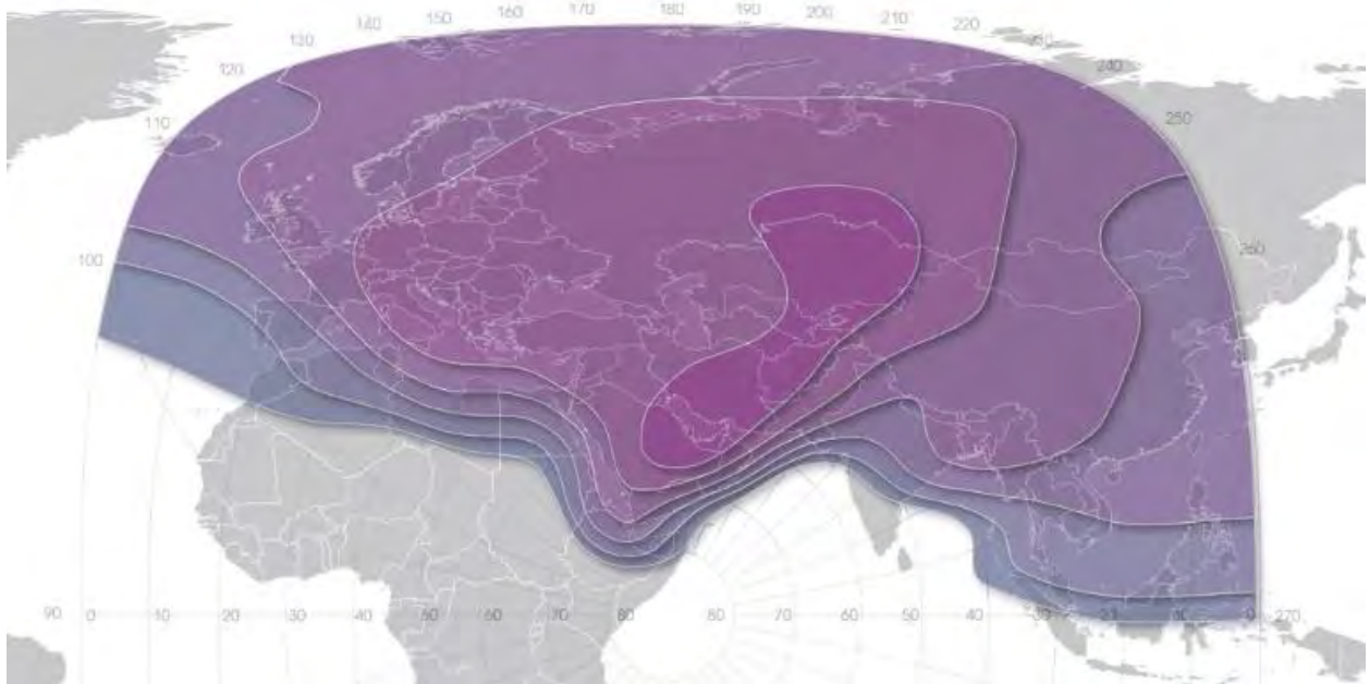
Рис. 70. Рабочие зоны ИСЗ ЯМАЛ-601 (49° в.д.) в S-диапазоне частот
