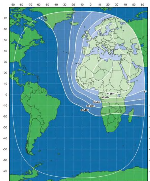
Рис. 47. ЭИИМ (дБВт) в рабочей зоне (африканский луч) ИСЗ ЭКСПРЕСС-АМ8 (14° з.д.) в С-диапазоне частот
