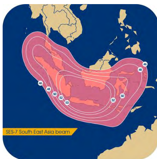
Рис. 54. ЭИИМ (дБ Вт) в рабочих зонах ИСЗ SES-7 (108,2° в.д.) в Ku-диапазоне частот
