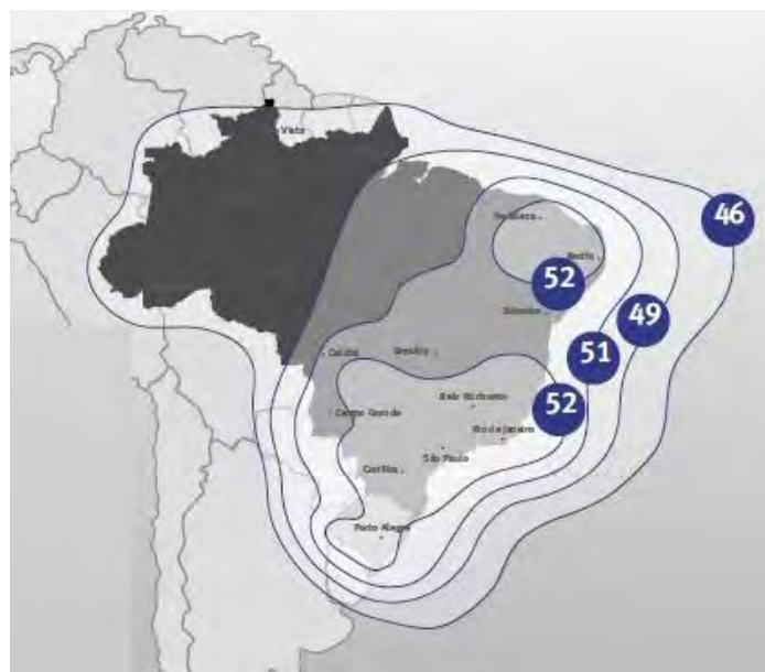
Рис. 24. ЭИИМ (дБ·Вт) в рабочих зонах (Бразилия) ИСЗ STAR ONE-D1 (84° з.д.) в С- (а) и Ku- (б) диапазонах частот
