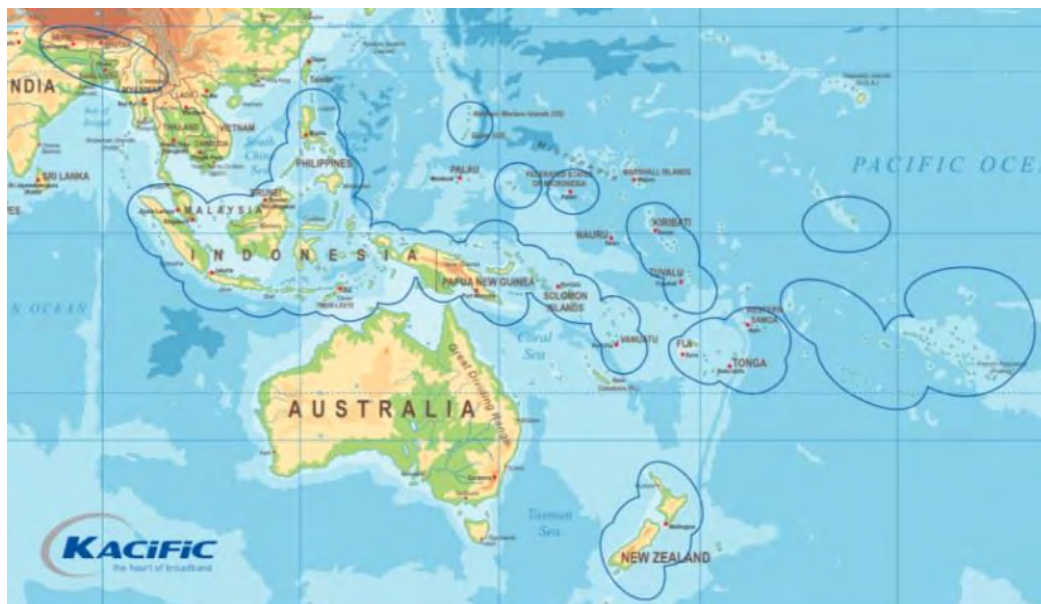
Рис. 10. Рабочие зоны ИСЗ KACIFIC-1 (150° в.д.) в Ka-диапазоне частот
