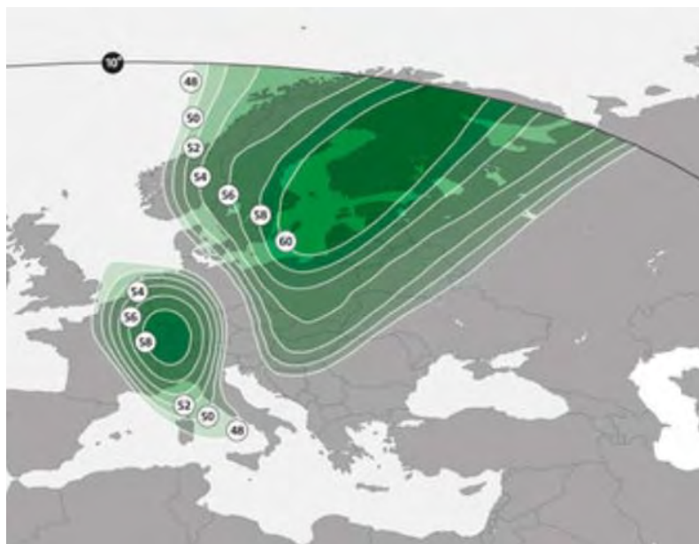
Рис. 45. ЭИИМ (дБ·Вт) в рабочих зонах на Европу ИСЗ ASTRA-4A (SIRIUS-4, 5° в.д.) в Ka-диапазоне частот
