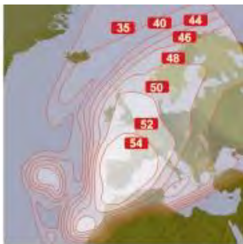
Рис. 3. ЭИИМ (дБ-Вт) в рабочей зоне (на Иберийскую Атлантику и Европу) ИСЗ HISPASAT-30W-4 (-1D) (30° з.д.) в Ku-диапазоне частот
