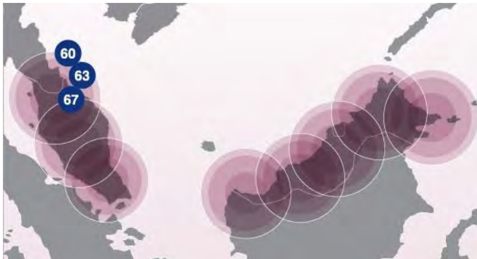
Рис. 12. ЭИИМ (дБ·Вт) в рабочих зонах ИСЗ MEASAT-3D (91,5° в.д.) в С- (а), Ку- (б) и Ка- (в) диапазонах частот
