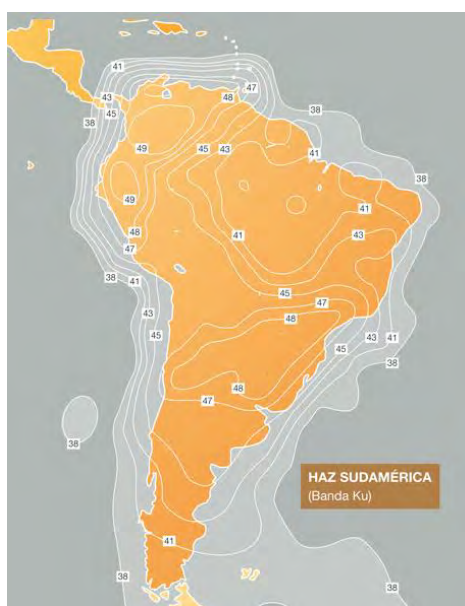
Рис. 29. ЭИИМ (дБ-Вт) в рабочей зоне (на Южную Америку) ИСЗ AMAZONAS-3 (61° з.д.) в Ku-диапазоне частот
