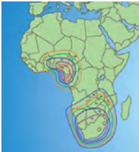
Рис. 15. Планирующаяся ЭИИМ (дБ·Вт) в рабочих зонах ИСЗ AFRICASAT-2A (5,7° в.д.) в Ku-диапазоне частот
