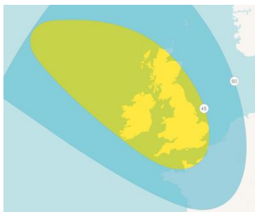
Рис. 72. ЭИИМ (дБ Вт) в рабочей зоне (Соединенное Королевство) ИСЗ ASTRA-1N (28,2° в.д.) в Ku-диапазоне частот
