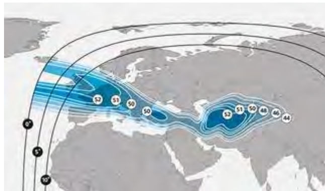
Рис. 109. ЭИИМ (дБ Вт) в рабочих зонах (восточная) ИСЗ MONACOSAT (52° в.д.) в Ku-диапазоне частот
