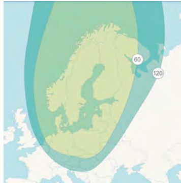
Рис. 42. Диаметры (см) антенн в рабочих зонах на Скандинавию ИСЗ ASTRA-4A (SIRIUS-4, 5° в.д.) в Ku-диапазоне частот
