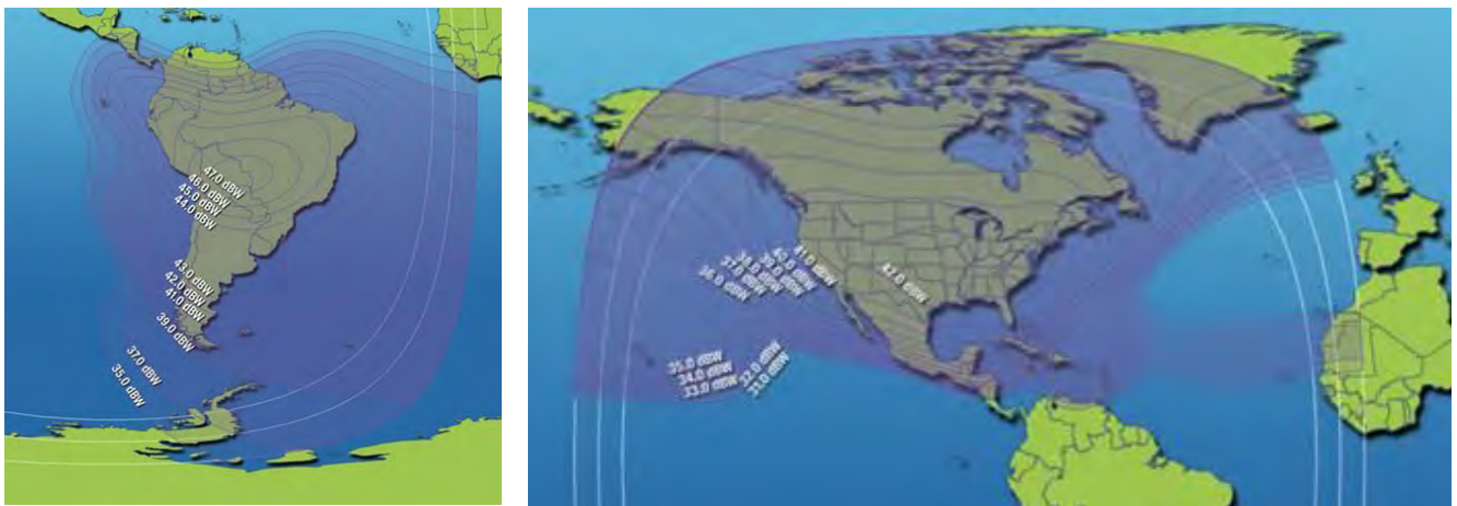
Рис. 57. Частотные планы ретрансляторов ИСЗ GALAXY-28 (INTELSAT-A8) в С- и Ку-диапазонах частот
