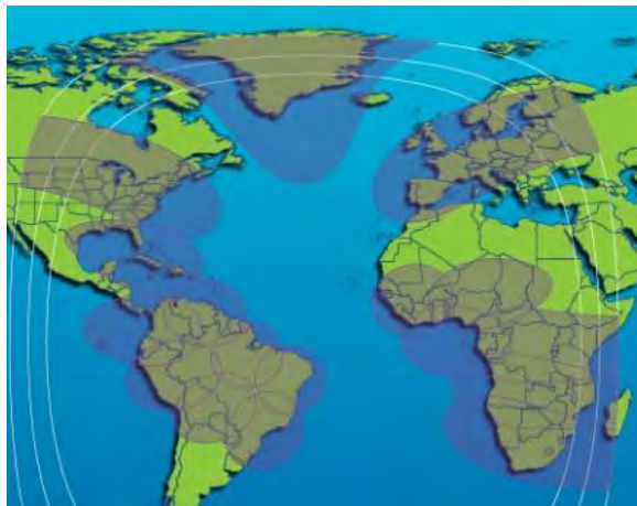
Рис. 115. ЭИИМ (дБ·Вт) в рабочих зонах (узкие лучи) ИСЗ INTELSAT-35e (34,5° з.д.) в С-диапазоне частот
