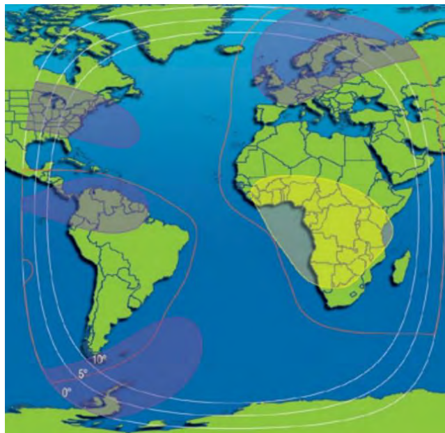
Рис. 119. Рабочие зоны ИСЗ INTELSAT-37e (18° з.д.) в C-диапазоне частот
