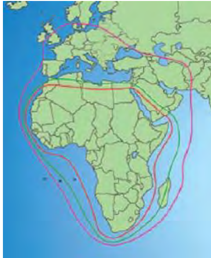
Рис. 14. Планирующаяся ЭИИМ (дБ·Вт) в рабочих зонах ИСЗ AFRICASAT-2A (5,7° в.д.) в С-диапазоне частот
