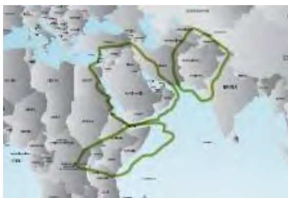
Рис. 17. Планировавшиеся рабочие зоны (три региональных луча) ИСЗ JABIRU-1 в Ka-диапазоне частот
