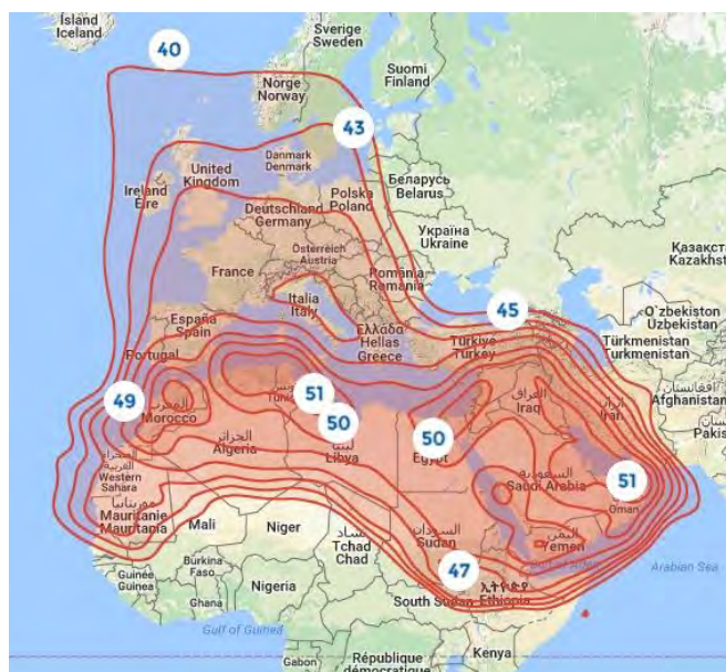
Рис. 5. Рабочие зоны (BSS) IC3 ARABSAT-4B (26° в.д.) в Ku-диапазоне частот
