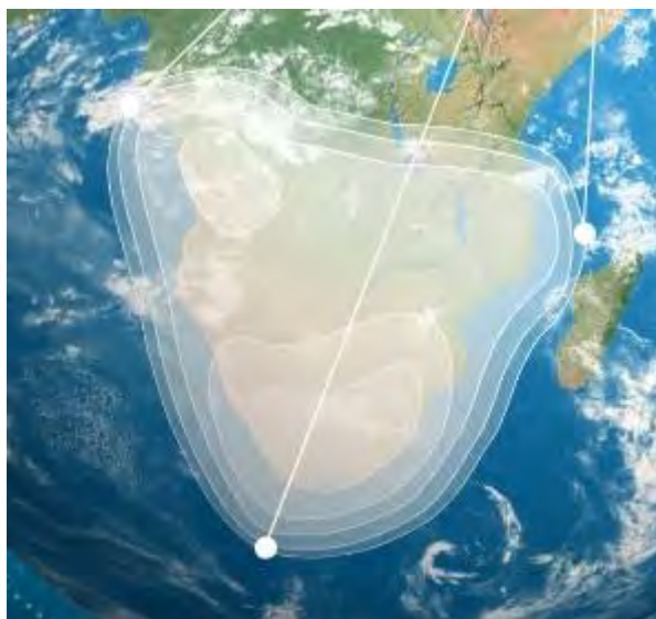
Рис. 36. Рабочие зоны (а – FSS, б – BSS, в – ME, г – SA) ИСЗ HELLAS-SAT-4 (39° в.д.) в Ku-диапазоне частот
