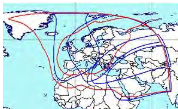
а) б) Рис. 7. Рабочие зоны (а) и ЭИИМ (дБ·Вт) в рабочих зонах (б) ИСЗ ATLANTIC BIRD-3 (5° з.д.) в С-диапазоне частот
