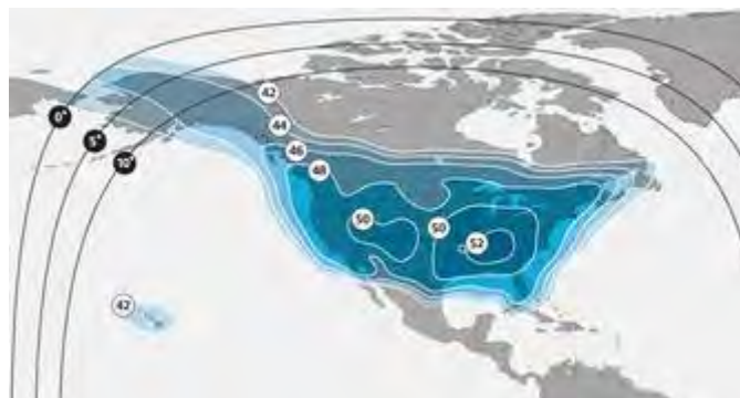
Рис. 71. ЭИИМ (дБ Вт) в рабочих зонах ИСЗ SES-3 (103° з.д.) в Ku-диапазоне частот
