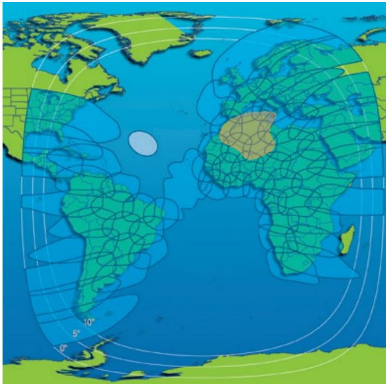
Рис. 121. Рабочие зоны (а – узкий луч, б – многолучевая диаграмма направленности) ИСЗ INTELSAT-37e (18° з.д.) в Ku-диапазоне частот
