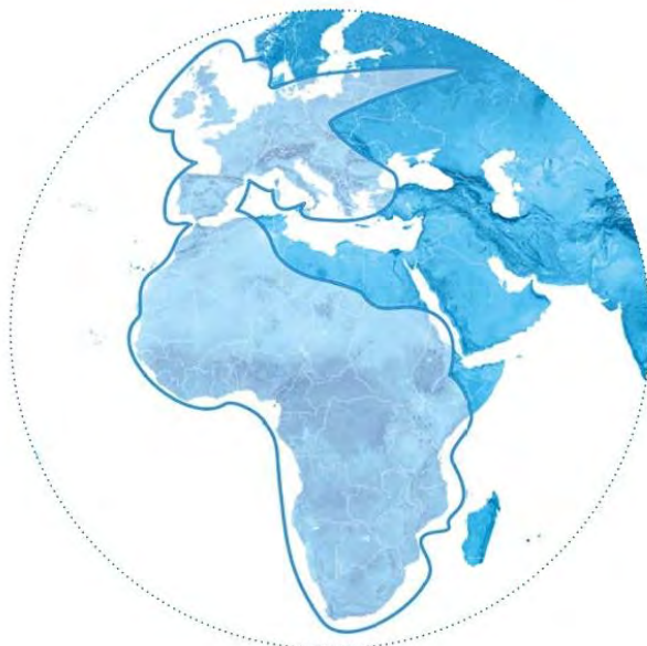
Рис. 38. Рабочие зоны ИСЗ HYLAS-4 (33,5° з.д.) в Ka-диапазоне частот
