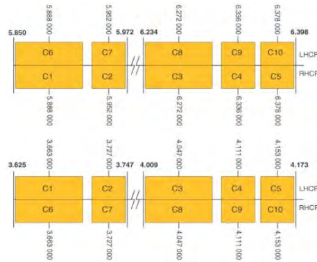
Рис. 5. Частотный план ретрансляторов ИСЗ STELLAT-5 в С-диапазоне частот
