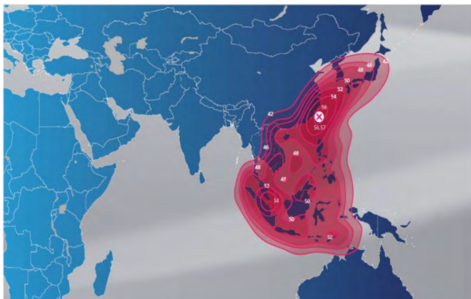
Рис. 33. ЭИИМ (дБ·Вт) в рабочих зонах (Юго-Восточная Азия) ИСЗ ST-2 (88° в.д.) в Ku-диапазоне частот
