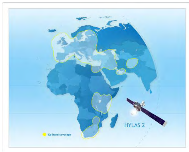
Рис. 36. Рабочие зоны ИСЗ HYLAS-2 (31° в.д.) в Ka-диапазоне частот
