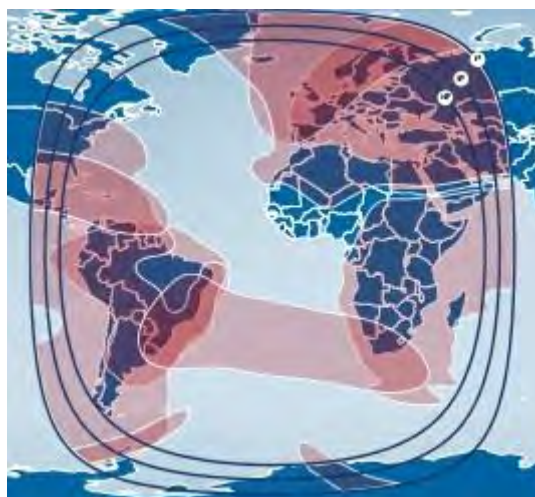
Рис. 50. Рабочие зоны ИСЗ TELSTAR-12 VANTAGE (15° з.д.) в Ku-диапазоне частот
