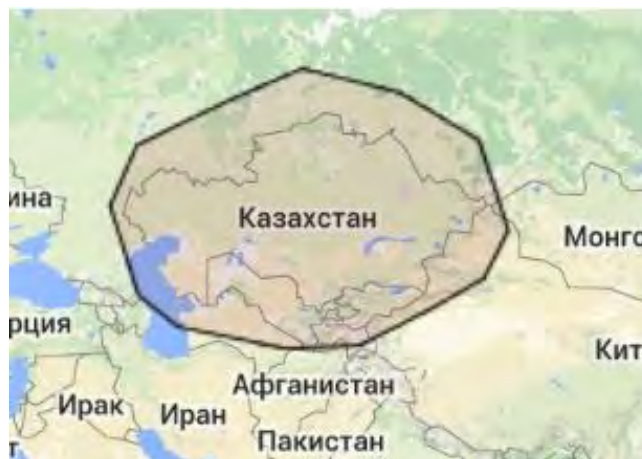
Рис. 5. Рабочая зона (перенацеливаемый луч) ИСЗ KAZSAT-3 (58,5° в.д.) в Ku-диапазоне частот
