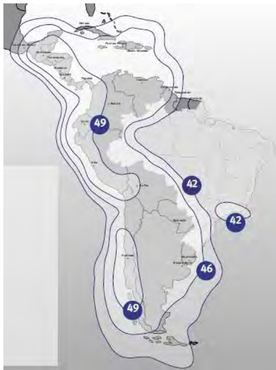
Рис. 21. ЭИИМ (дБ·Вт) в рабочих зонах (Латинская Америка) ИСЗ STAR ONE-C4 (70° з.д.) в Ku-диапазоне частот
