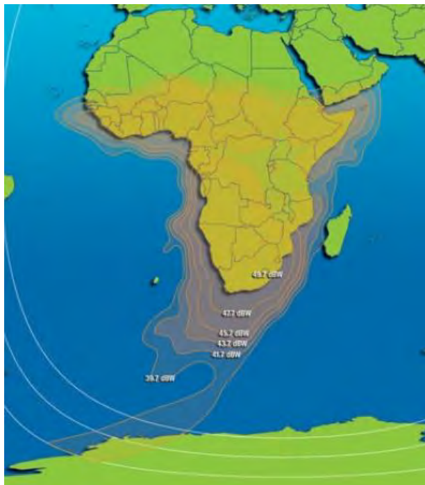
Рис. 1. ЭИИМ (дБ·Вт) в рабочих зонах ИСЗ INTELSAT-28 NEW DAWN (33° в.д.) в Ku-диапазоне частот
