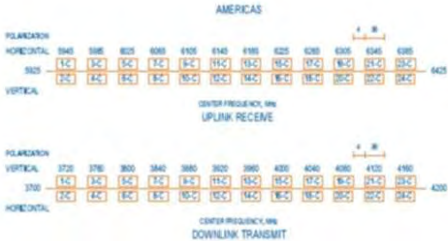
Рис. 7. Частотный план ретрансляторов ИСЗ INTELSAT-9 (PAS-9) в С-диапазоне частот
