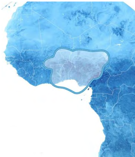
Рис. 39. Рабочие зоны ИСЗ HYLAS-3 (31° в.д.) в Ka-диапазоне частот
