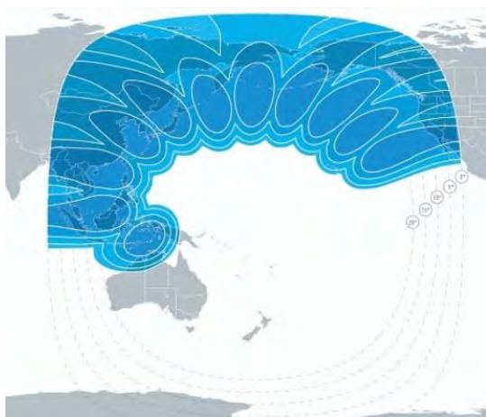
Рис. 17. ЭИИМ (дБ·Вт) в рабочих зонах (многолучевая диаграмма направленности на северо-восточную Азию и север Тихого океана) ИСЗ GE-23 (172° в.д.) в Ku-диапазоне частот
