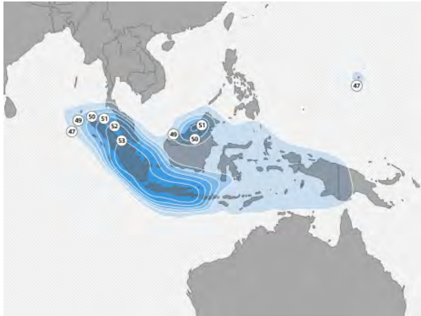
Рис. 115. ЭИИМ (дБ Вт) в рабочих зонах (Индонезия) ИСЗ SES-9 (108,2° в.д.) в Ки-диапазоне частот
