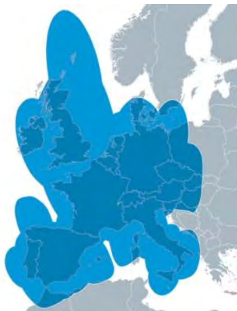
6) Рис. 78. Рабочие зоны (а – на «подсахарную» Африку, б – на западную Европу) ИСЗ EUTESAT-KONNECT (7° в.д.) в Ka-диапазоне частот
