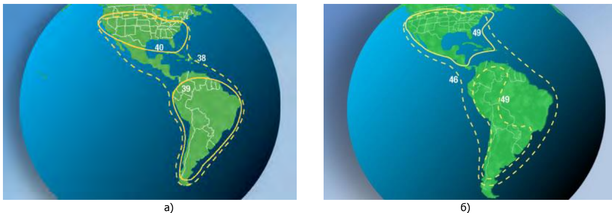
Рис. 21. ЭИИМ (дБ·Вт) в рабочих зонах ИСЗ SATMEX-6 (113° з.д.) в С- (а) и Ku- (б) диапазонах частот
