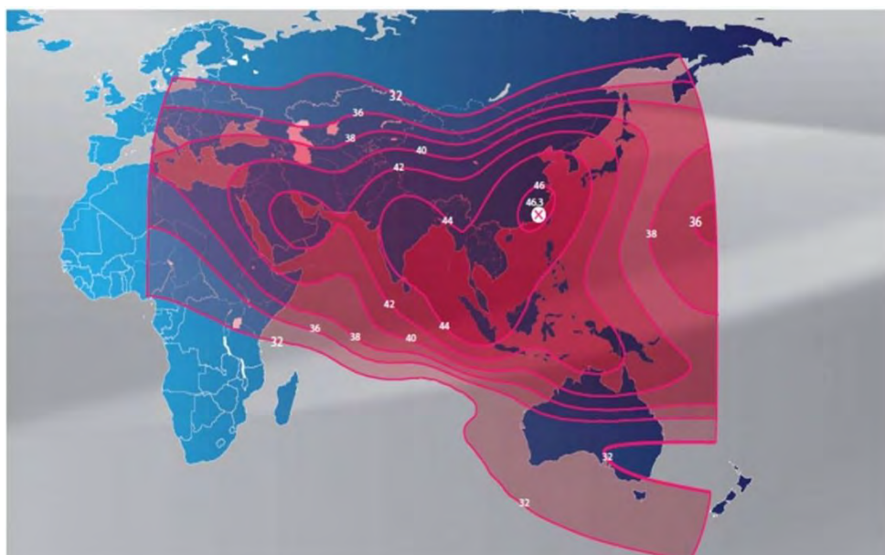
Рис. 31. Рабочие зоны (а) и ЭИИМ (дБ·Вт) в рабочих зонах (б) ИСЗ ST-2 (88° в.д.) в С-диапазоне частот
