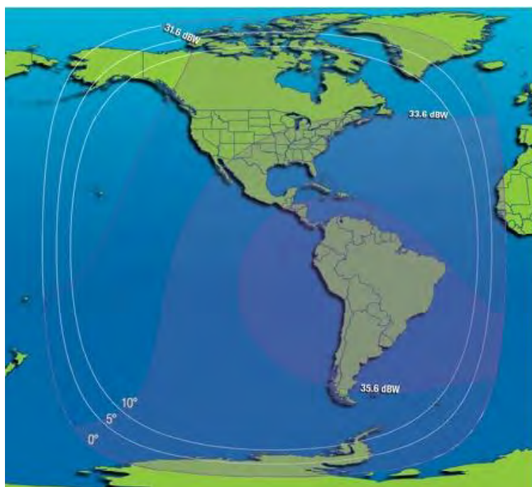
Рис. 107. ЭИИМ (дБ·Вт) в рабочих зонах (полуглобальный луч) ИСЗ INTELSAT-30 (95° з.д.) в C-диапазоне частот
