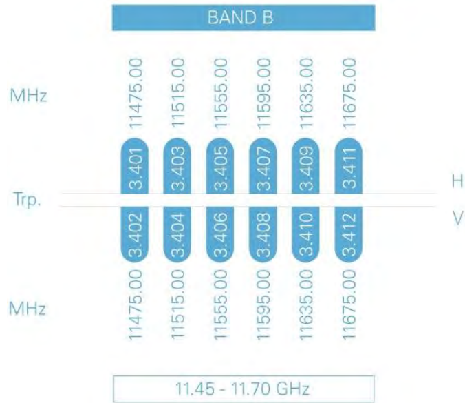
Рис. 65. Частотный план (а - для Европы, б - для Ближнего Востока) ретрансляторов ИСЗ ASTRA-3B в Ku-диапазоне частот
