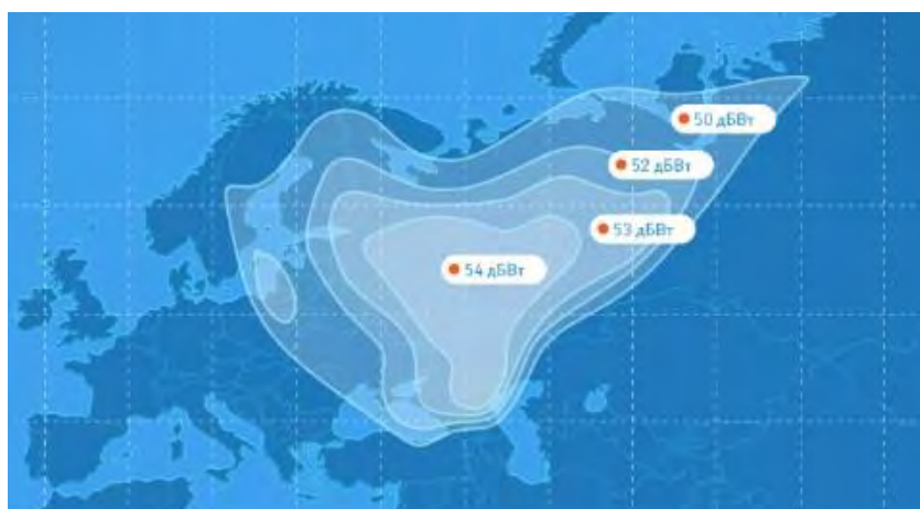
Рис. 52. ЭИИМ (дБ·Вт) в рабочей зоне (1-й фиксированный луч) ИСЗ ЭКСПРЕСС-АМУ-1 (36° в.д.) в Ku-диапазоне частот
