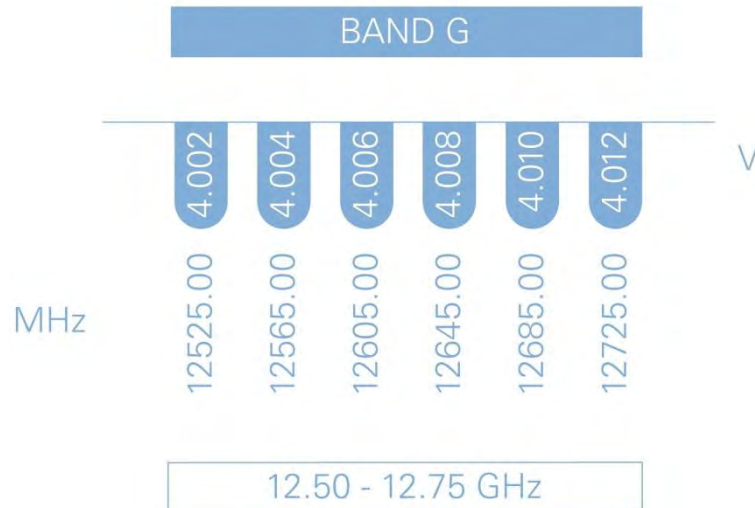
Рис. 40. Частотный план ретрансляторов ИСЗ ASTRA-4A в Ku-диапазоне частот
