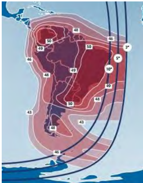
Рис. 47. ЭИИМ (дБ·Вт) в рабочих зонах ИСЗ ANIK-G1 (107,3° з.д.) в Ku-диапазоне частот
