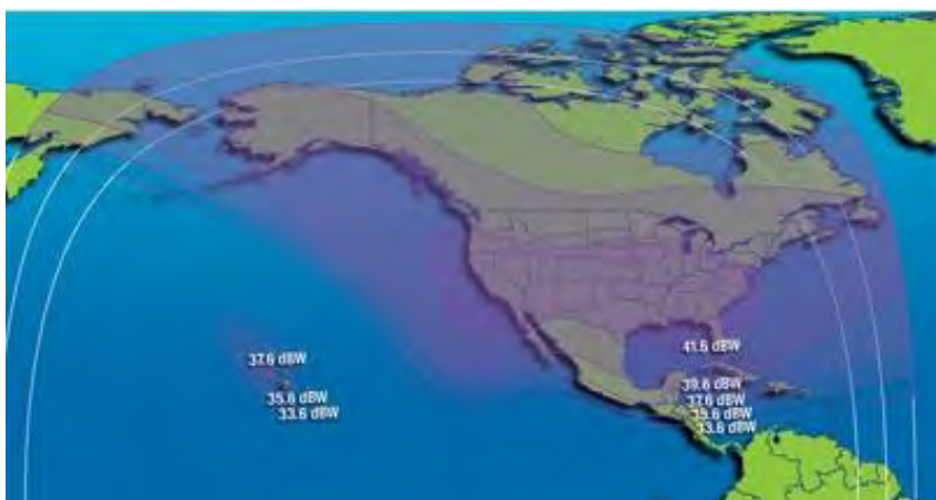
Рис. 49. ЭИИМ (дБ-Вт) в рабочих зонах (горизонтальная поляризация) ИСЗ GALAXY-12 (129° з.д.) в С-диапазоне частот
