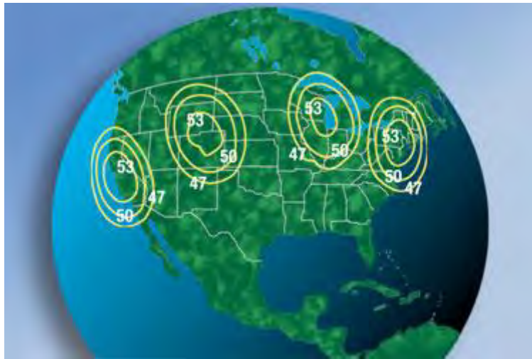
Рис. 62. ЭИИМ (дБ-Вт) в рабочих зонах ИСЗ GALAXY-28 (INTELSAT-A8, 89° з.д.) в Ka-диапазоне частот
