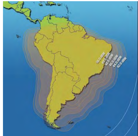
Рис. 59. ЭИИМ (дБ·Вт) в южноамериканской рабочей зоне ИСЗ GALAXY-28 (INTELSAT-A8, 89° з.д.) в Ku-диапазоне частот
