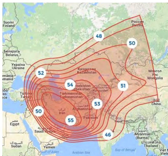
Рис. 23. ЭИИМ (дБ·Вт) в рабочих зонах (BSS, central Asia) ИСЗ ARABSAT-5B (26° в.д.) в Ku-диапазоне частот
