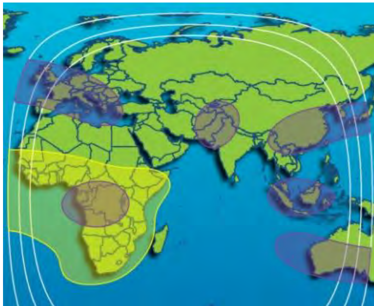
Рис. 111. ЭИИМ (дБ·Вт) в рабочих зонах (экваториальная и Южная Африка, узкие лучи) ИСЗ INTELSAT-33e (60° в.д.) в С-диапазоне частот
