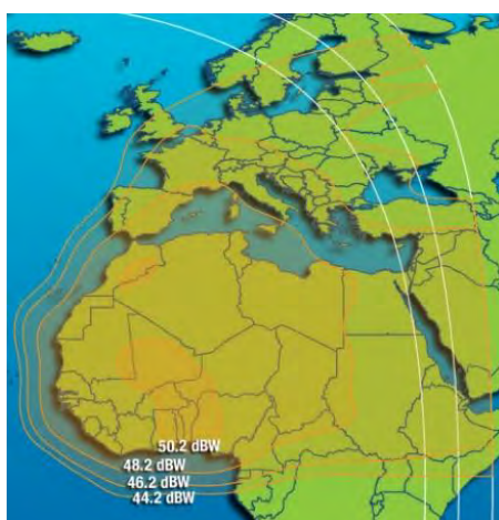
Рис. 116. ЭИИМ (дБ·Вт) в рабочих зонах (Африка и Европа) ИСЗ INTELSAT-35e (34,5° з.д.) в Ku-диапазоне частот
