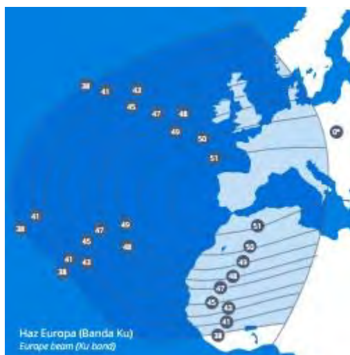
Рис. 31. ЭИИМ (дБ-Вт) в рабочей зоне (Европа) ИСЗ AMAZONAS-3 (61° з.д.) в Ku-диапазоне частот
