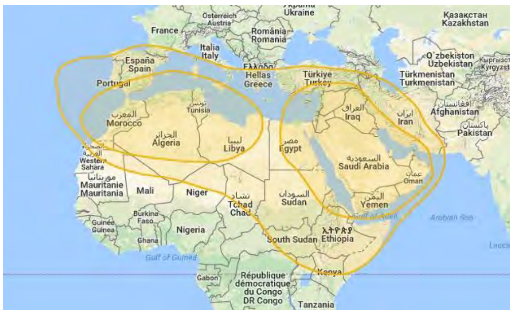
Рис. 32. Рабочие зоны ИСЗ BADR-7 (26° в.д.) в Ка-диапазоне частот
