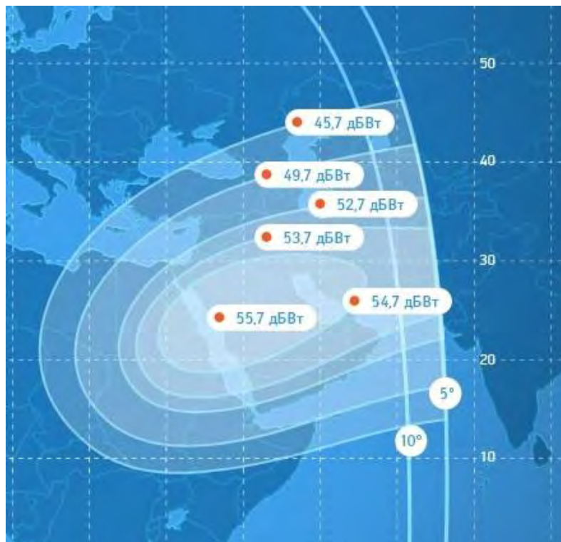
Рис. 14. ЭИИМ (дБ·Вт) в рабочей зоне (2-й вариант перенацеливаемого луча) ИСЗ ЭКСПРЕСС-АМ44 (11° з.д.) в Ku-диапазоне частот
