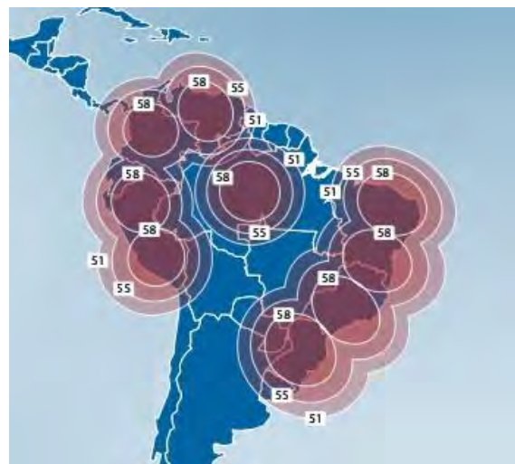
Рис. 54. ЭИИМ (дБ·Вт) в рабочих зонах (по девять узких лучей) ИСЗ TELSTAR-19 VANTAGE (63° з.д.) в Ки-диапазоне частот
