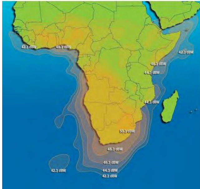
Рис. 85. ЭИИМ (дБ-Вт) в рабочих зонах ИСЗ INTELSAT-28 (NEW DAWN) (33° в.д.) в Ku-диапазоне частот
