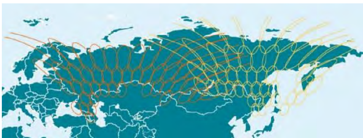
Рис. 78. Планирующиеся рабочие зоны ИСЗ ЭКСПРЕСС-ВСД2 (60° в.д.) и ЭКСПРЕСС-ВСД1 (133° в.д.) в Ка-диапазоне частот
