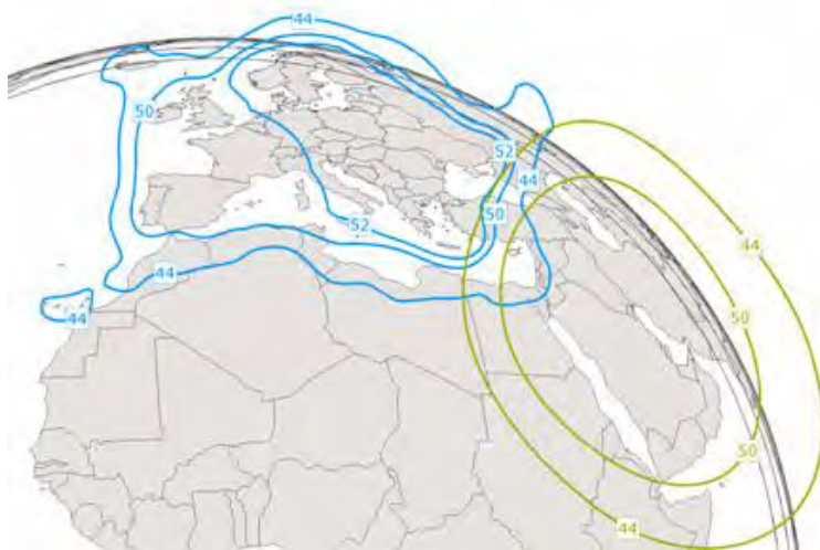
Рис. 5. ЭИИМ (дБ·Вт) в рабочих зонах (перенацеливаемый луч) ИСЗ THOR-5 (0,7° з.д.) в Ku-диапазоне частот
