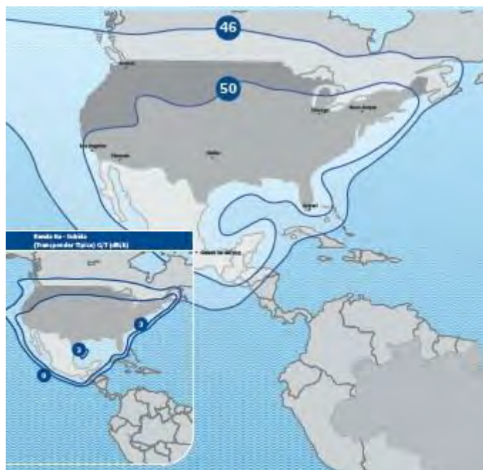
Рис. 13. ЭИИМ (дБ·Вт) в рабочих зонах (Северная Америка) ИСЗ HISPASAT-74W-1 (STAR ONE-C4) (70° з.д.) в Ku-диапазоне частот
