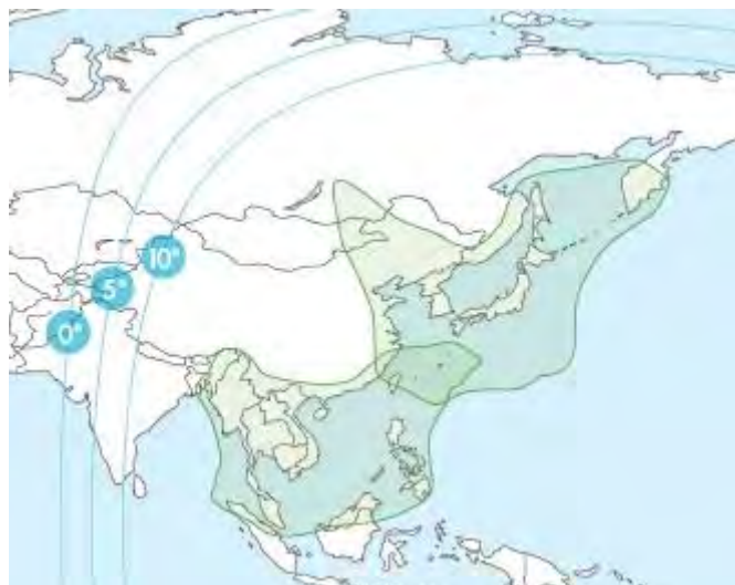
Рис. 22. Рабочие зоны ИСЗ JCSAT-18 (150° в.д.) в Ku-диапазоне частот
