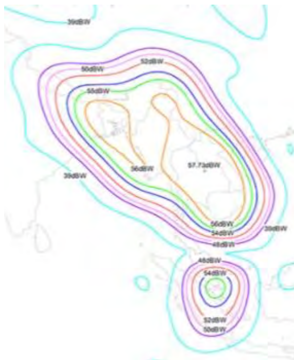
Рис. 2. ЭИИМ (дБ-Вт) в рабочих зонах ИСЗ LAOSAT-1 (128,5° в.д.) в Ku-диапазоне частот
