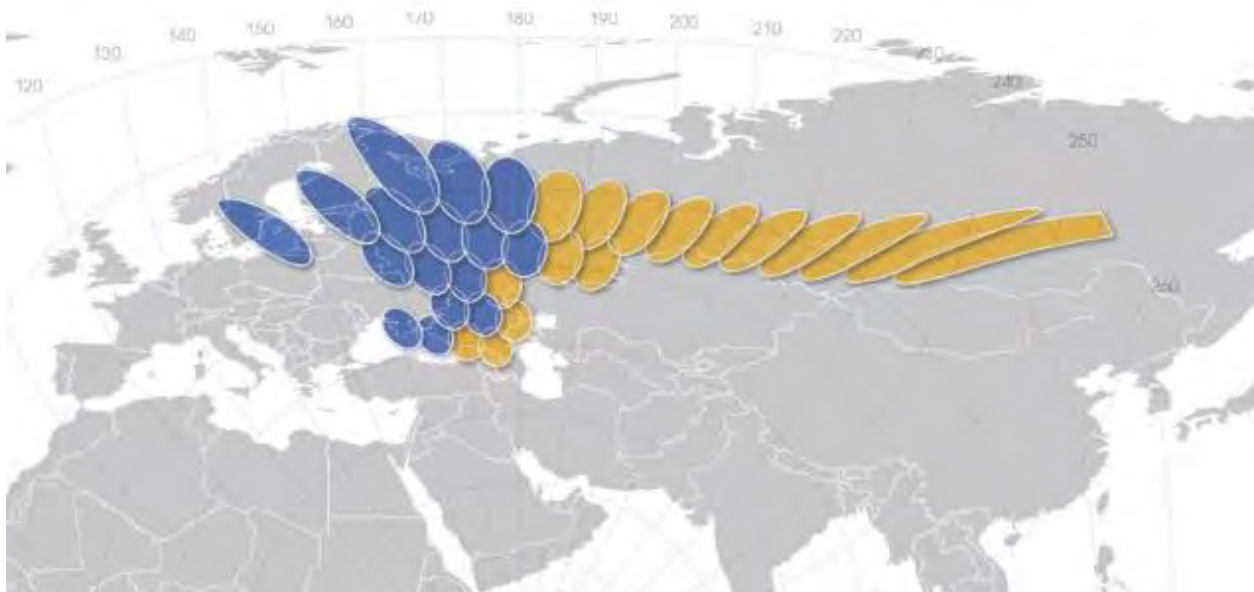
Рис. 72. Рабочие зоны ИСЗ ЯМАЛ-601 (49° в.д.) в Ка-диапазоне частот
