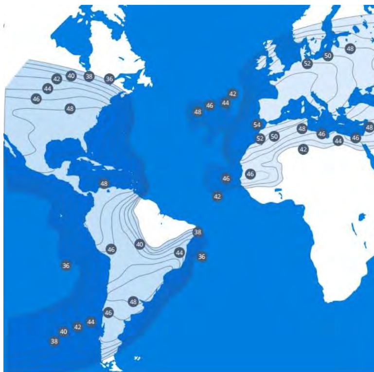
Рис. 7. ЭИИМ (дБ-Вт) в рабочих зонах ИСЗ HISPASAT-30W-5 (-1E) (30° з.д.) в Ku-диапазоне частот
