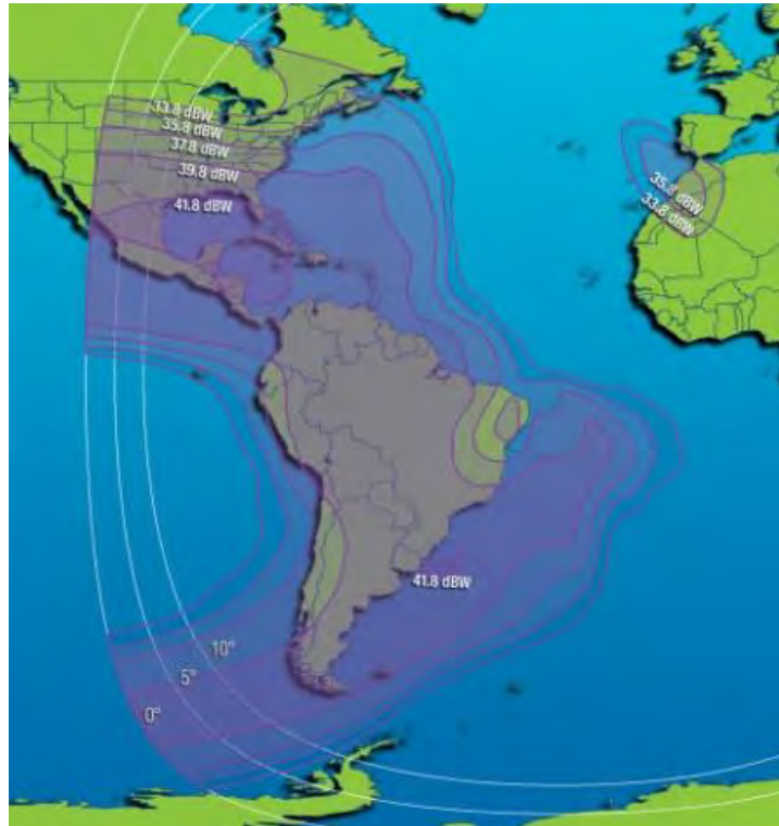
Рис. 10. ЭИИМ (дБ·Вт) в рабочих зонах ИСЗ INTELSAT-9 (PAS-9, 29,5° з.д.) в С-диапазоне частот
