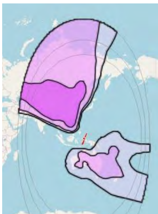
Рис. 23. Рабочие зоны (полуглобальная) ИСЗ CHINASAT-6C (130° в.д.) в С-диапазоне частот
