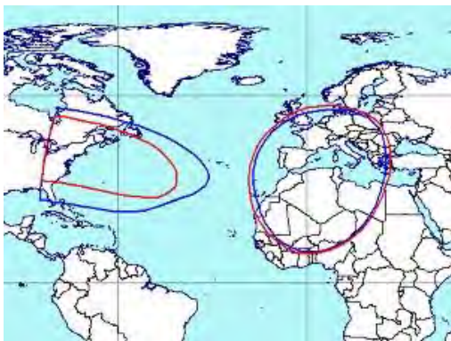
а) б) Рис. 7. Рабочие зоны (а) и ЭИИМ (дБ·Вт) в рабочих зонах (б) ИСЗ ATLANTIC BIRD-3 (5° з.д.) в С-диапазоне частот
