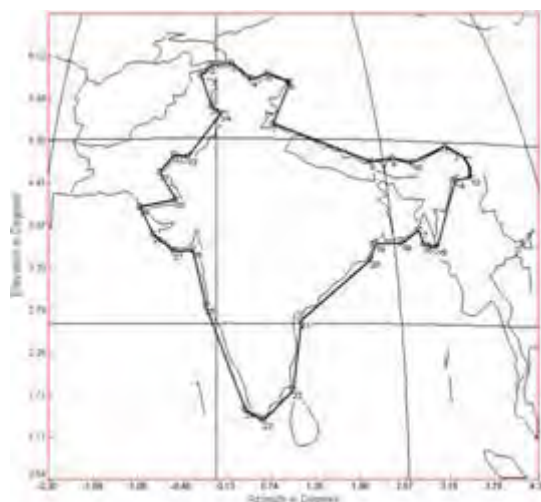
Рис. 6. Рабочая зона ИСЗ GSAT-15 (93,5° в.д.) в Ku-диапазоне частот
