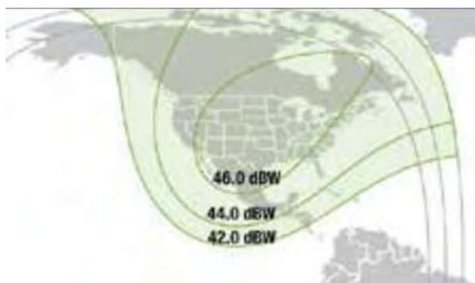
Рис. 1.35. ЭИИМ (дБ·Вт) в рабочих зонах (Мексика, США и Канада) ИСЗ GALAXY-31 (121° з.д.) в Ka-диапазоне частот
