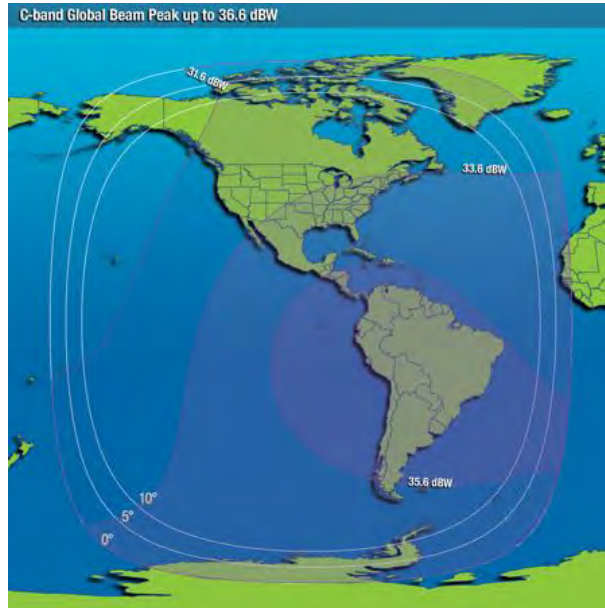
Рис. 109. ЭИИМ (дБ·Вт) в рабочих зонах (полуглобальный луч) ИСЗ INTELSAT-31 (95° з.д.) в С-диапазоне частот
