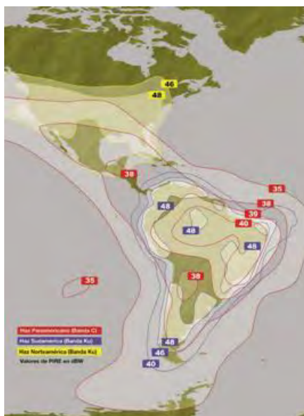
Рис. 23. Рабочие зоны ИСЗ AMAZONAS-2 (61° з.д.) в С- и Ку-диапазонах частот
