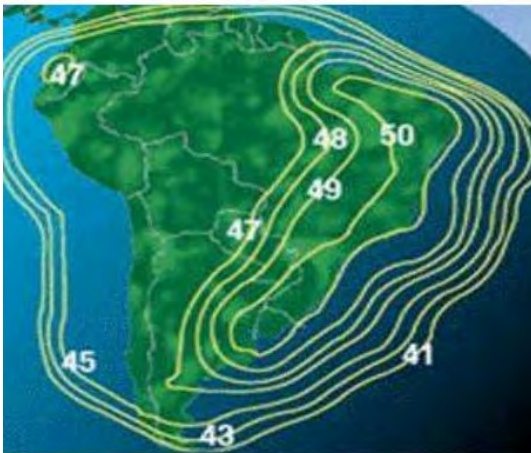
Рис. 59. ЭИИМ (дБ·Вт) в южноамериканской рабочей зоне ИСЗ GALAXY-28 (INTELSAT-A8, 89° з.д.) в Ku-диапазоне частот
