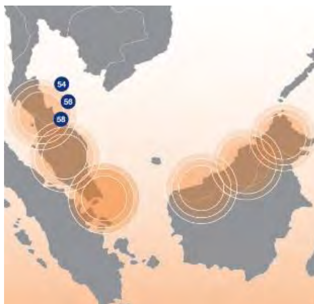
Рис. 7. ЭИИМ (дБ·Вт) в рабочих зонах ИСЗ MEASAT-5 (119,5° в.д.) в Ku-диапазоне частот
