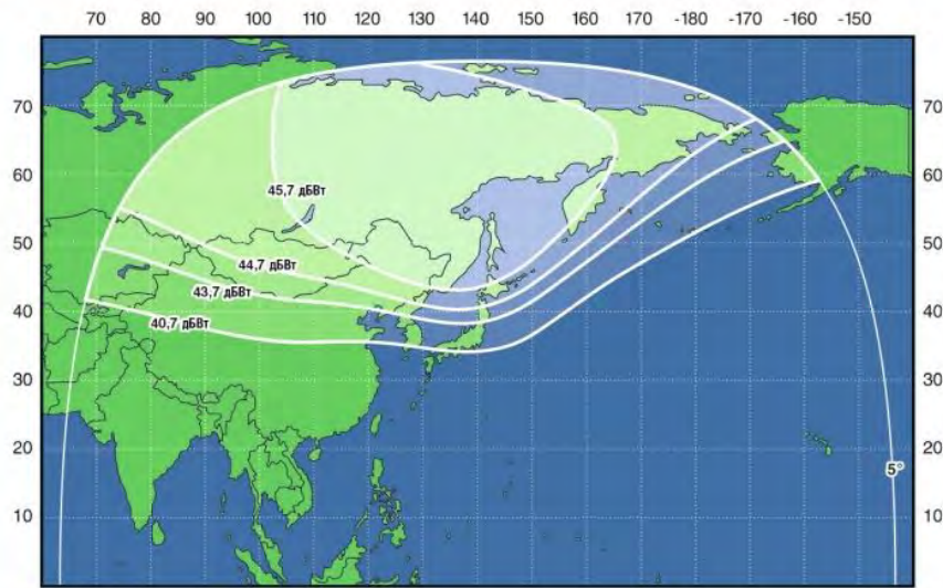
Рис. 19. ЭИИМ (дБ·Вт) в рабочей зоне (фиксированный луч) ИСЗ ЭКСПРЕСС-АМ5 (140° в.д.) в С-диапазоне частот
