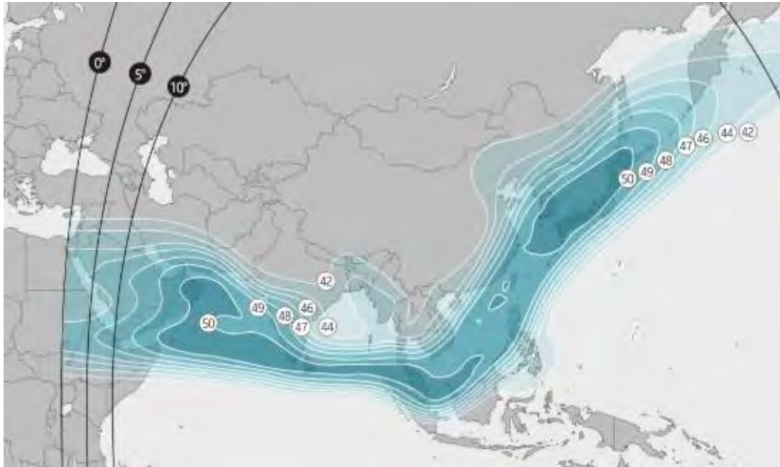
Рис. 12. ЭИИМ (дБ-Вт) в рабочих зонах (морские потребители) ИСЗ KOREASAT-5A (113° в.д.) в Ku-диапазоне частот
